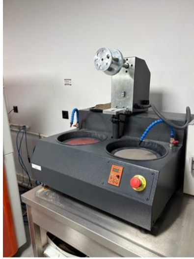
Şekil 2.2. Zımpara makinesi, Brightway MT S2, MTC Metalurji, Türkiye
