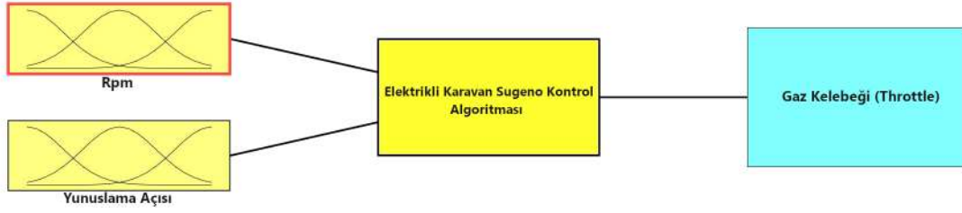
Şekil 4.15. Sugeno Kontrolcü Şeması
