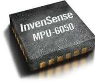
Şekil 3.4. Ataletsel Ölçüm Birimi [87]
