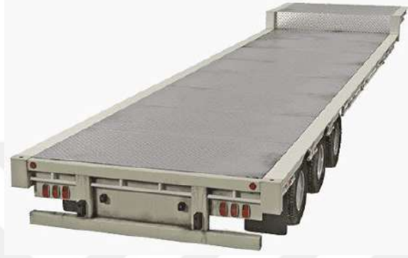
Şekil 2.2. Düz Yataklı Treyler[2]
