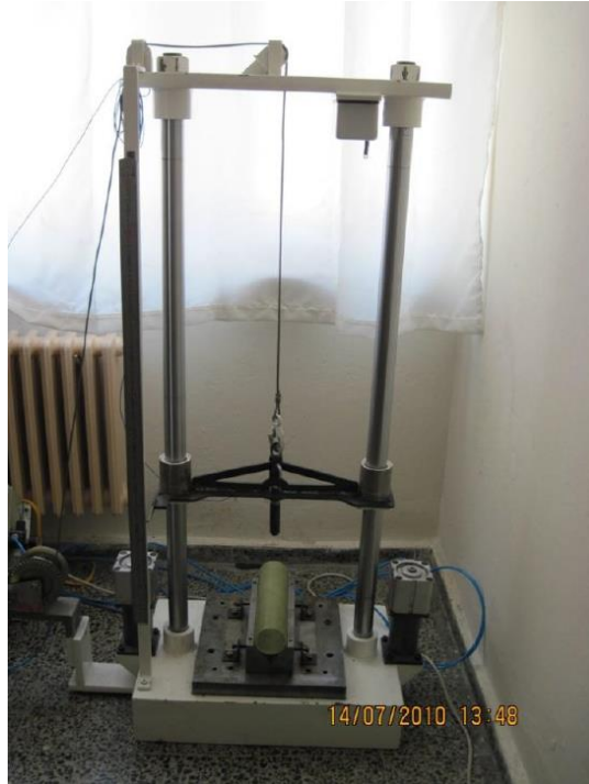
Şekil 4.8 Düşük hızlı darbe sistemi (Kara, 2012)
