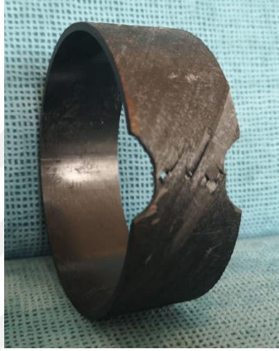
Şekil 4.6 Prosedür A'ya göre hazırlanıp çekme testi uygulanmış numune
