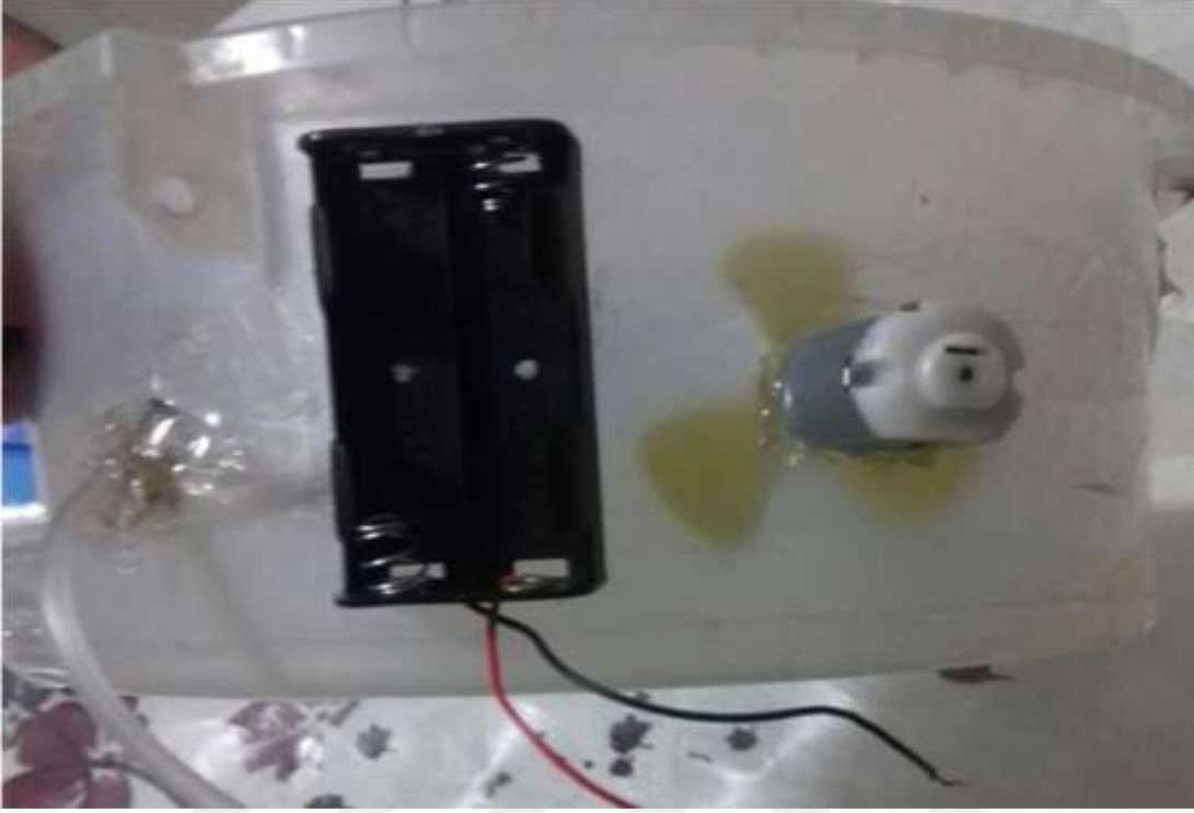
Şekil-5: Öğrenciler çalışmalarında havalandırma havuzu için güç kaynağı kullandılar.
