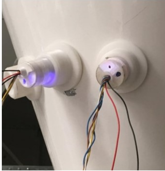
Şekil 3.2. Kapasitif Yaklaşım Sensörünün Sahaya Bağlanması.
