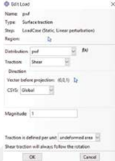
Şekil 6.15 Dikdörtgen silo doldurma durumunda P_{wf} yükünün silo duvarına aktarılması
