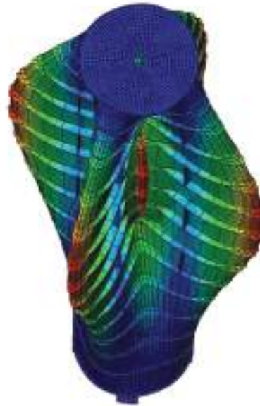
Şekil 6.79 Silindir silo mod şekilleri: 10. ve 11. modlar
