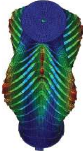
Şekil 6.79 Silindir silo mod şekilleri: 10. ve 11. modlar
