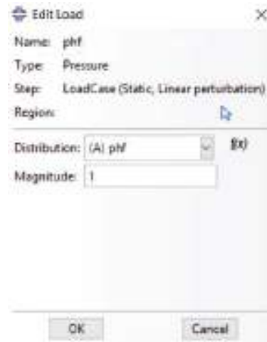
Şekil 6.13 P_{hf} yükünün silo iç duvarına uygulanması
