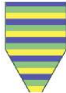
Şekil 3.11 Silo içi malzemelerin kütle akışı şekli (Özel, 2007)
