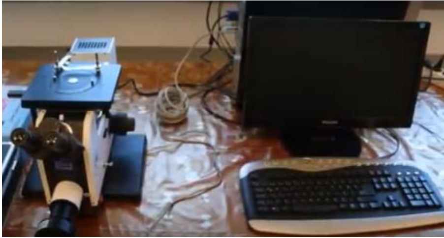
Şekil 4.9. Mikro yapı incelemeleri amacıyla kullanılan optik mikroskop
