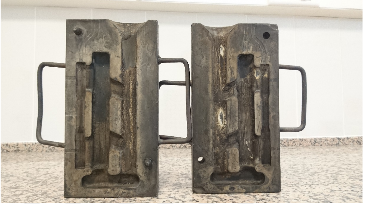
Şekil 4.3. H13 çeliğinden imal edilen kokil kalıp
