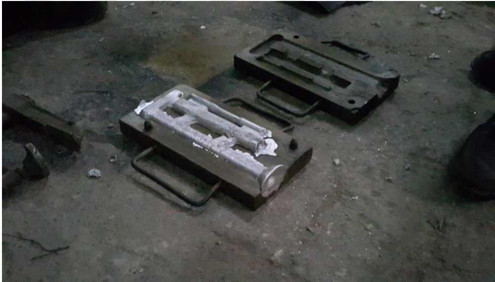
Şekil 5.26. 800°C sıcaklıkta gerçekleştirilen döküm işlemi
