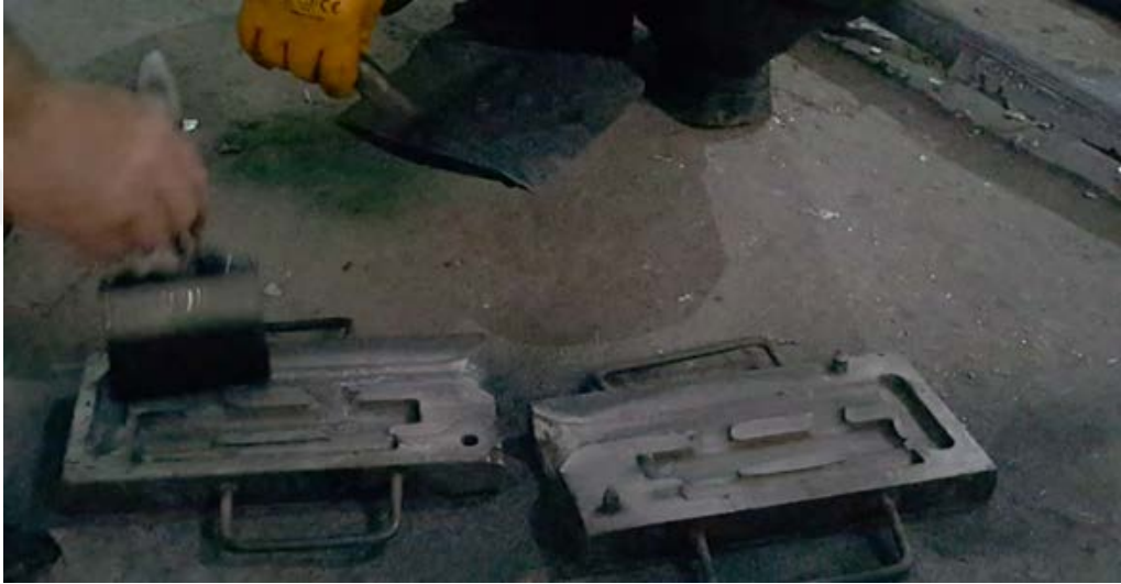
Şekil 4.5. Döküm öncesi kokil kalıp hazırlığı
