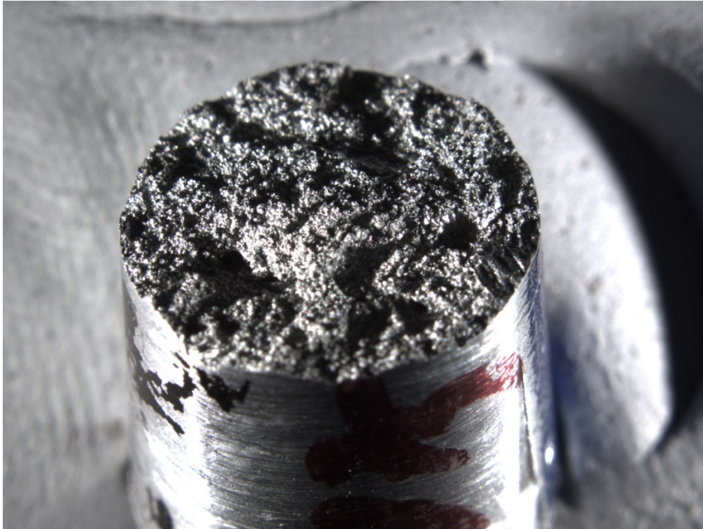
Şekil 5.32. AA 7075 alüminyum alaşımının çekme gerilme testinden sonra kırık yüzey morfolojisi
