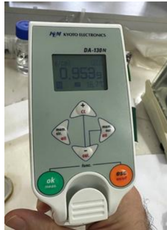
Şekil 3.11. Çalışmada kullanılan portatif yoğunluk ölçer cihazı
