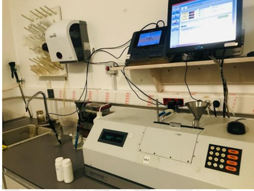
Şekil 3.5.Çalışmada kullanılan sakkarimetre cihazı
