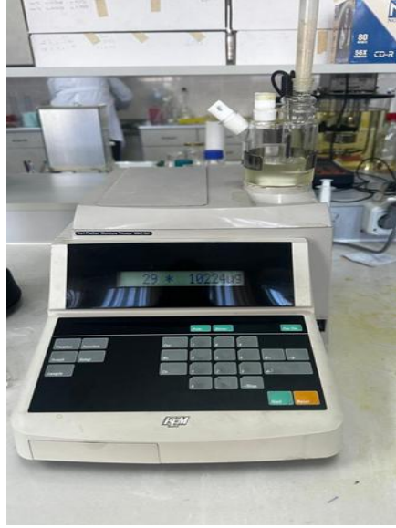
Şekil 3.12. Çalışmada kullanılan otomatik kalorimetrik karl fischer titratörü
