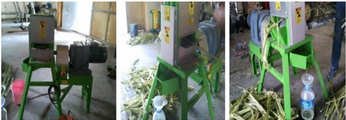
Şekil 3.2. Tatlı sorgumun özsularının çıkarıldığı pres makinası ve sapların sıkılmasından görüntüler
