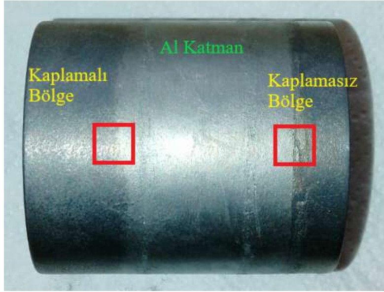
Şekil 3.22. Al 6035 Lama Haddelme İşleminde Sonraki Merdane
