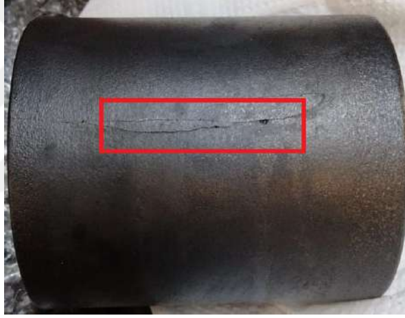
Şekil 3.19. St 37 Lama Haddeleme İşleminde Sonra Yüzeyde Oluşan Çatlak
