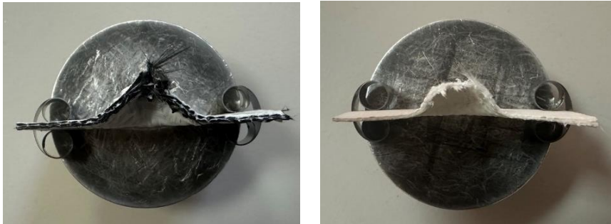
Şekil 4.37. SEM görüntüsü alınan örnek Erichsen testi numune görüntüleri
