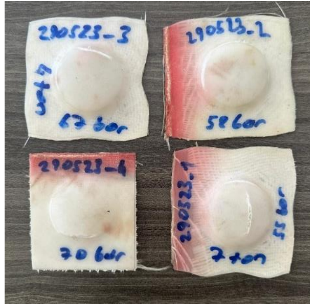
Şekil Ek-1.1. 9x9 cm boyutundaki numunelerde deney sonrası oluşan yırtılmalar
