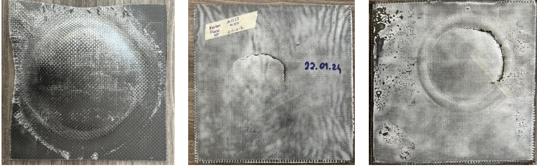
Şekil Ek-1.5. Süzdürme çubuksuz yuvarlak kalıp ile hidroşekillendirme deneyi sonrası görüntüler
