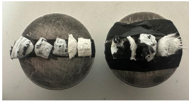
Şekil 4.36. SEM görüntüsü alınan örnek çekme testi numune görüntüleri
