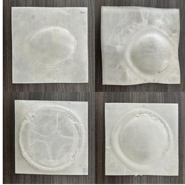
Şekil Ek-1.4. 17,5×17,5 cm boyutundaki numunelerinin farklı kalıp geometrilerinde hidroşekillendirme sonuçları
