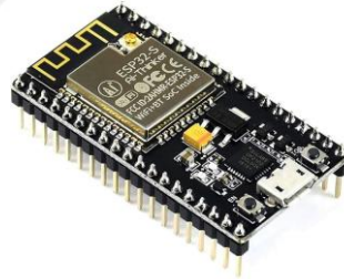
Şekil 3.6. NodeMCU sensörü (URL-7, 2022)
