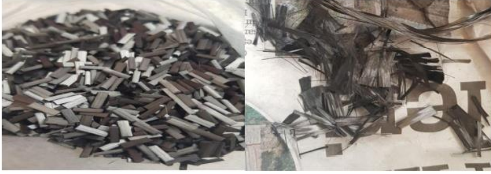
Şekil 1.12. Karbon elyaf parçaları (Uzanalioğlu H., 2021)
