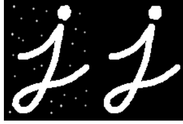
Şekil 3.22. 3x3 Maske kullanılarak yapılan açma işlemi
