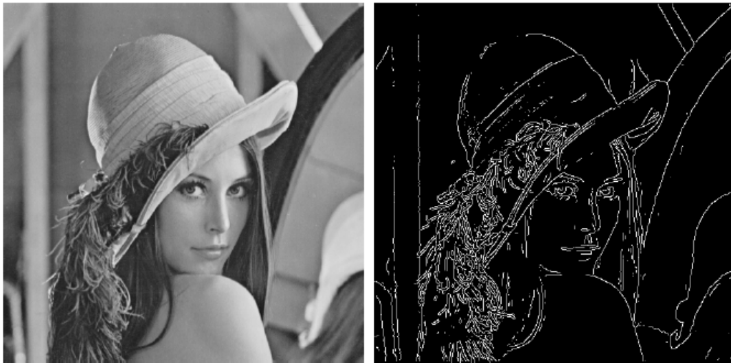
Şekil 3.24. Örnek görüntü ve çıkartılmış kenar görüntüsü
