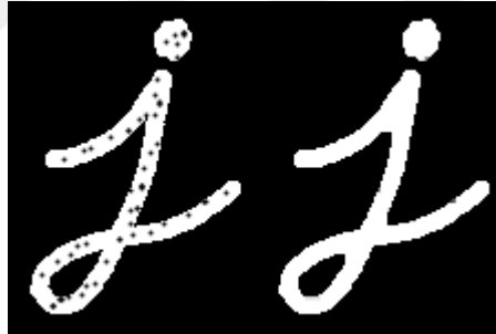
Şekil 3.23. 3x3 Maske kullanılarak yapılan kapatma işlemi
