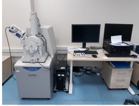
Şekil 3.13: HITACHI SU1510 markalı SEM cihazın görüntüsü
