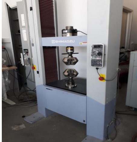
Şekil 3.18: SHIMADZU AG-X PLUS marka çekme cihazın görüntüsü
