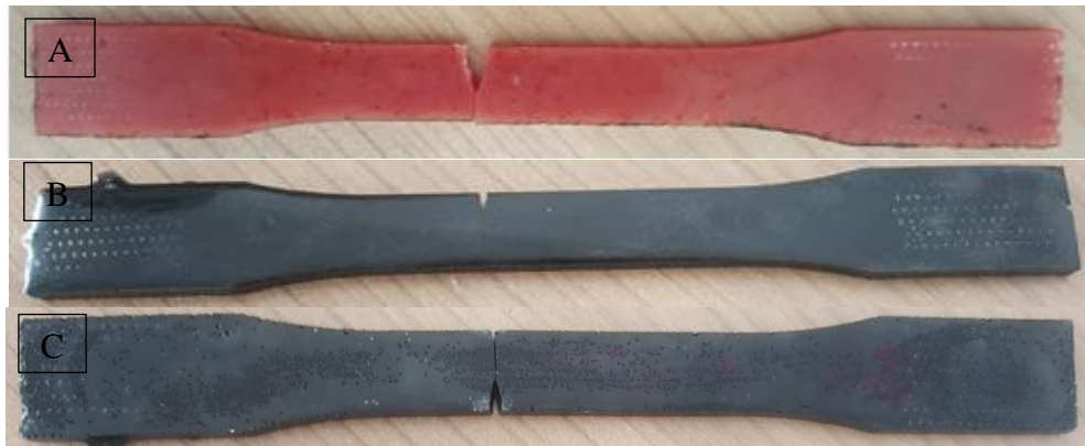
Şekil 4.7: Üretilen kompozit numunelerinin çekme sonrası görüntüleri A) Katkısız fenolik B) %0.01 CNT katkıli kompozit C) %0.01 GNP katkıli kompozit
