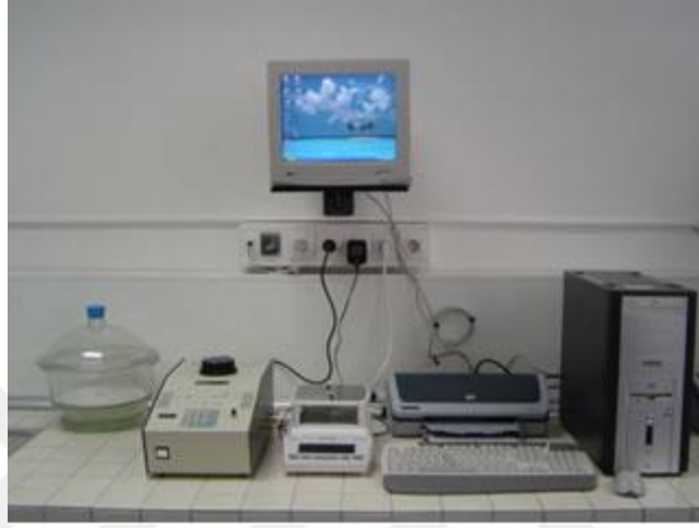
Şekil 3.19: ACCUPYC II 1340 markalı yoğunluk ölçüm cihazı
