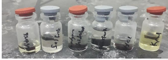
Şekil.4.10: Kompozit malzemelerin kimyasal ortamda bekletilmesi
