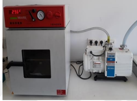
Resim 3.5: Binder VD 23 marka etüv
