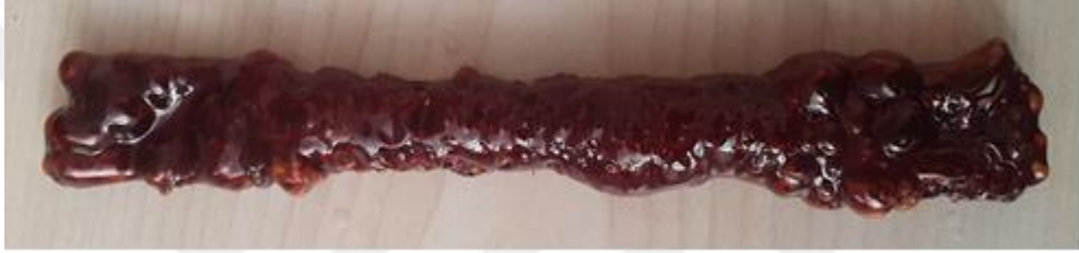
Şekil 3.9: Teflon kalıp uygulamasındaki köpük oluşumu
