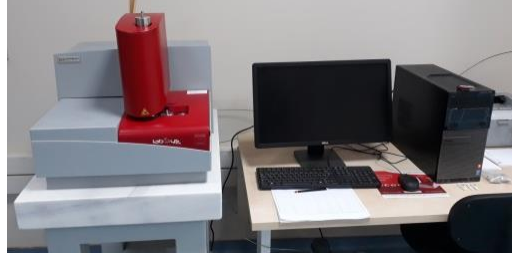
Şekil 3.15: SETARAM LABSYS EVO 1-A marka cihazın görüntüsü
