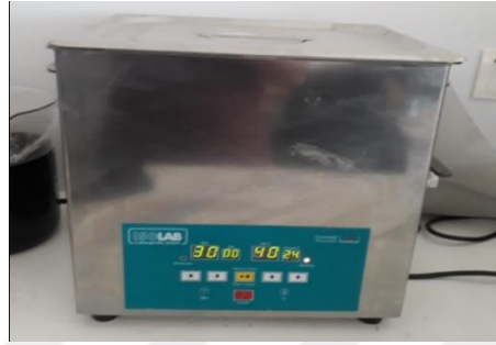
Şekil 3.7: ISOLAB Ultrasonik Banyo markalı cihazın görüntüsü
