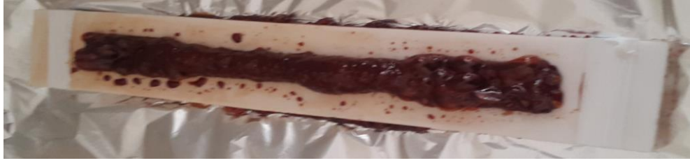
Şekil 3.8: Teflon kalıp ile fenolik reçine kürleme uygulaması
