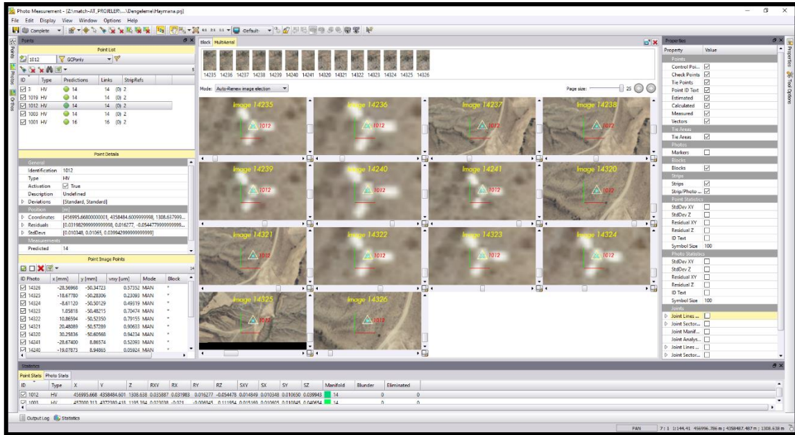
Şekil 5.13 Yer Kontrol Noktalarının Fotoğraflarda İşaretleme İşlemi.
