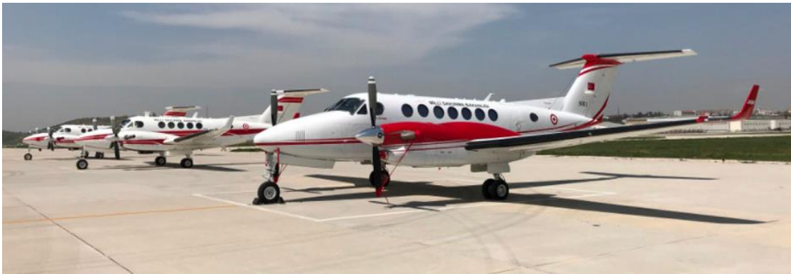
Şekil 3.12 Beechcraft Super King Air B-200 (2 Adet) Model ile B-350 ER model hava fotoğrafı çekim uçağı (URL 2).
