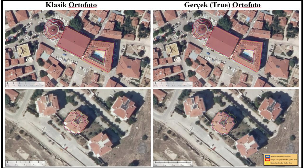
Şekil 5.32 Stere Modelden, Klasik Ortofoto ve Gerçek (True) Ortofoto Üzerinden Çizilen Vektör Bina Verilerinin Karşılaştırılması.
