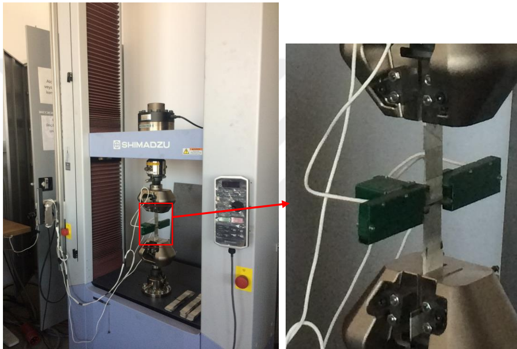
Şekil 3.3.1.2.: Yapıştırılmalı bağlantının Shimadzu AGS-X cihazında çekme testi
