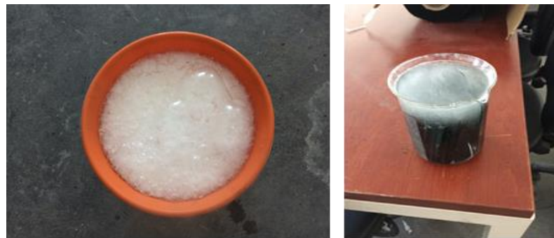
Şekil 3.4.1.: 90°C'de Alkalin ile temizleme ve 43°C'deki saf su ile yıkama
