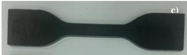
Şekil 3.7. 1.: a) Çekme numunesinin kalıba dökülmesi, b) Kalıba dökülen çekme numuneleri, c) Üretilen çekme numunesi örneği
