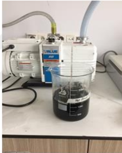
Şekil 3.4.2.: 65-71 °C'deki Sülfirik asit ve sodyum dikromat ile dağlama işlemi
