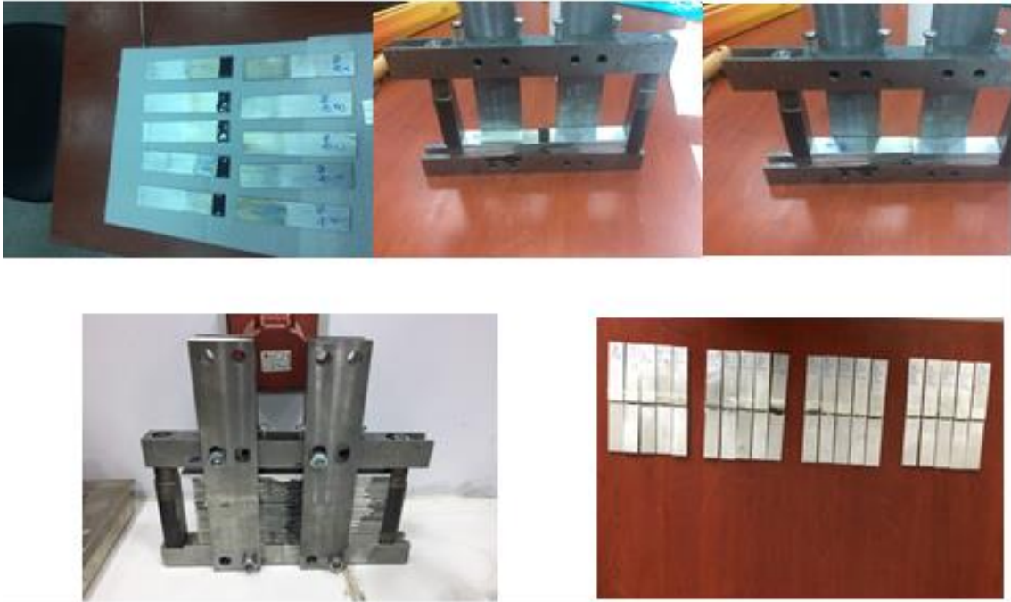
Şekil 3.6.1.: Üretilen Lap-Shear numunelerinin yapıştırma ve kurutma süreci
