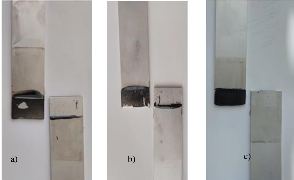
Şekil 4.2.: Kayma dayanım testleri sonucunda oluşan hasar mekanizmaları a) 015Gr015KNT b) 015Gr050KNT c) 050Gr050KNT numuneleri
