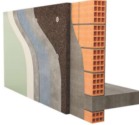
Şekil 2. Dış cephe ısı yalıtımı uygulaması (URL-5, 2023)
