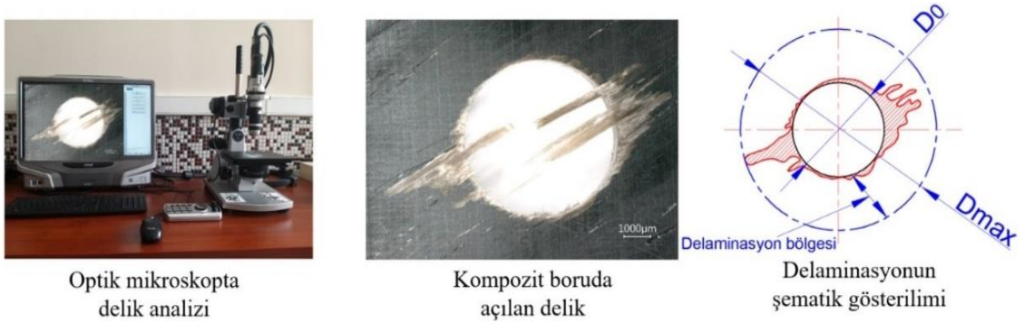
Şekil 4.6. Optik mikroskop ve delaminasyon faktörü hesaplaması
