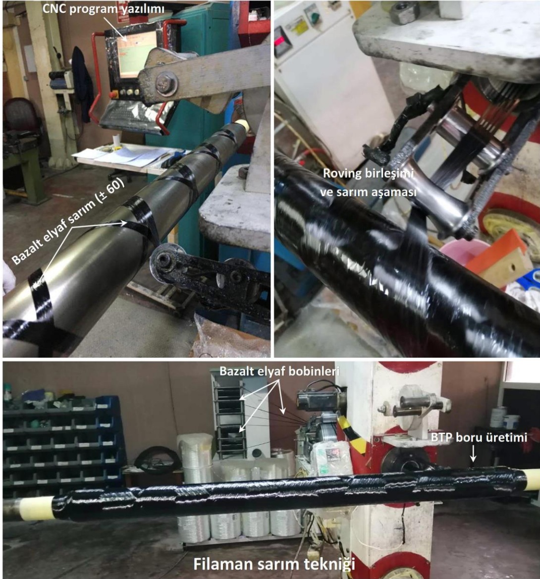
Şekil 4.1. BTP kompozit boruların üretimi
