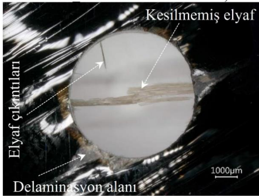
CP_3- Delik girişi (iş mili dönme hızı:1000 dev/dk ilerleme hızı:300 mm/dk)
