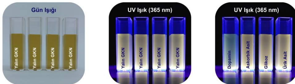
Şekil 4.15. Yalın ve hedef analitler varlığında (10 µM) GKN çözeltisinin gün ve UV ışık altındaki fotoğrafları
