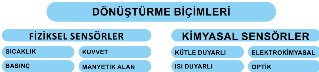
Şekil 1.20. Sensörlerin dönüştürme biçimlerine göre sınıflandırılması
