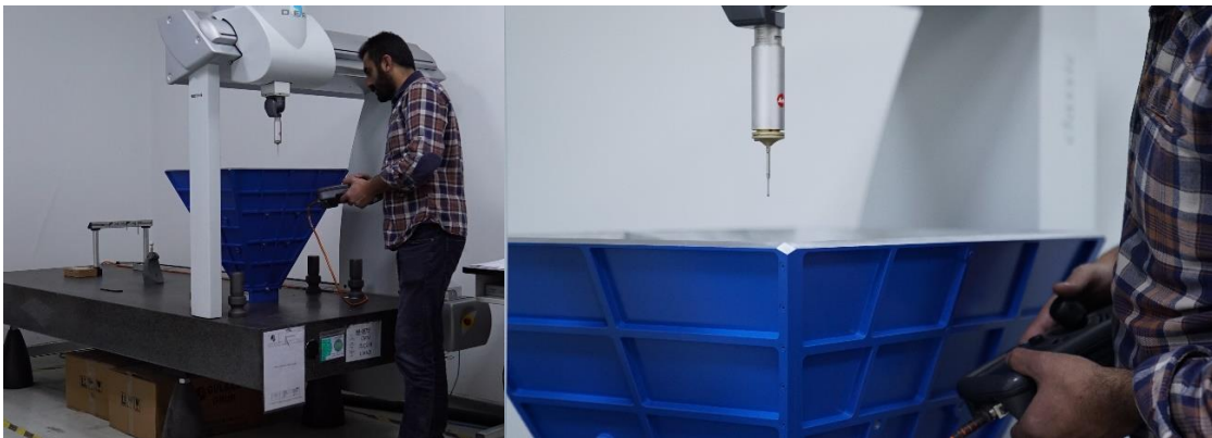
Şekil 3.23. SMM Cihazındaki Anten Ölçü Kontrolü
