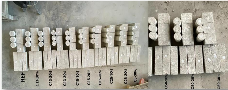
Şekil 3. 4. Seri 1 – Hazırlanmış Beton Numuneler
