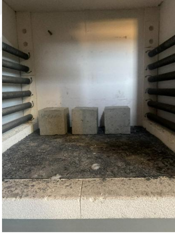
Şekil 3. 7. Fırın içerisine yerleştirilen beton küp numuneleri.
