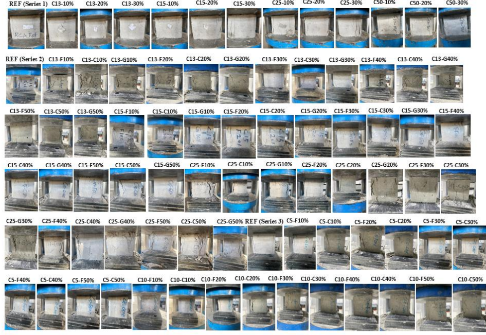
Şekil 4. 14. Seri 1, Seri 2 ve Seri 3'teki tüm beton numunelerin basınçlı kırılma modelleri.
