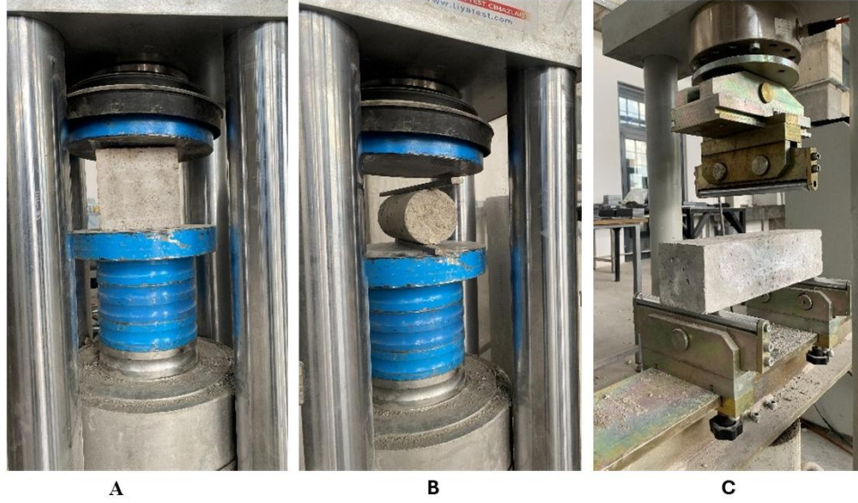
Şekil 3. 3. (a) Basınç Dayanımı. (b) Yarma Çekme Dayanımı. (c) Eğilme Dayanımı.
