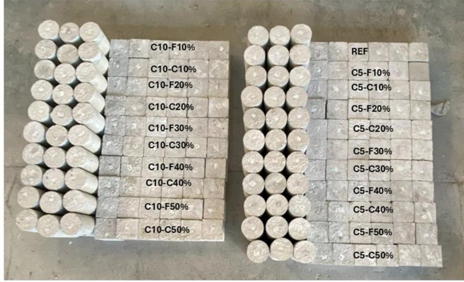
Şekil 3. 6. Seri 3 – Hazırlanmış Beton Numuneler
