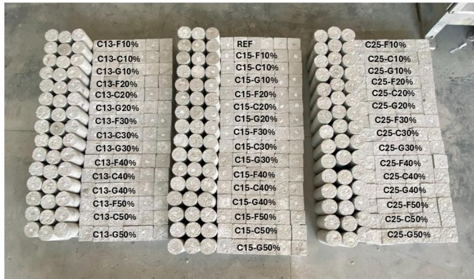
Şekil 3. 5. Seri 2 – Hazırlanmış Beton Numuneler
