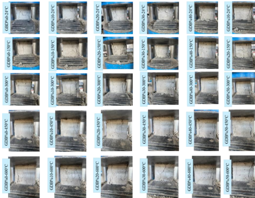
Şekil 4. 16. Farklı GDB ikame oranlarına sahip beton numunelerinin yüksek sıcaklıklardan sonra basınç kırılma şekilleri.
