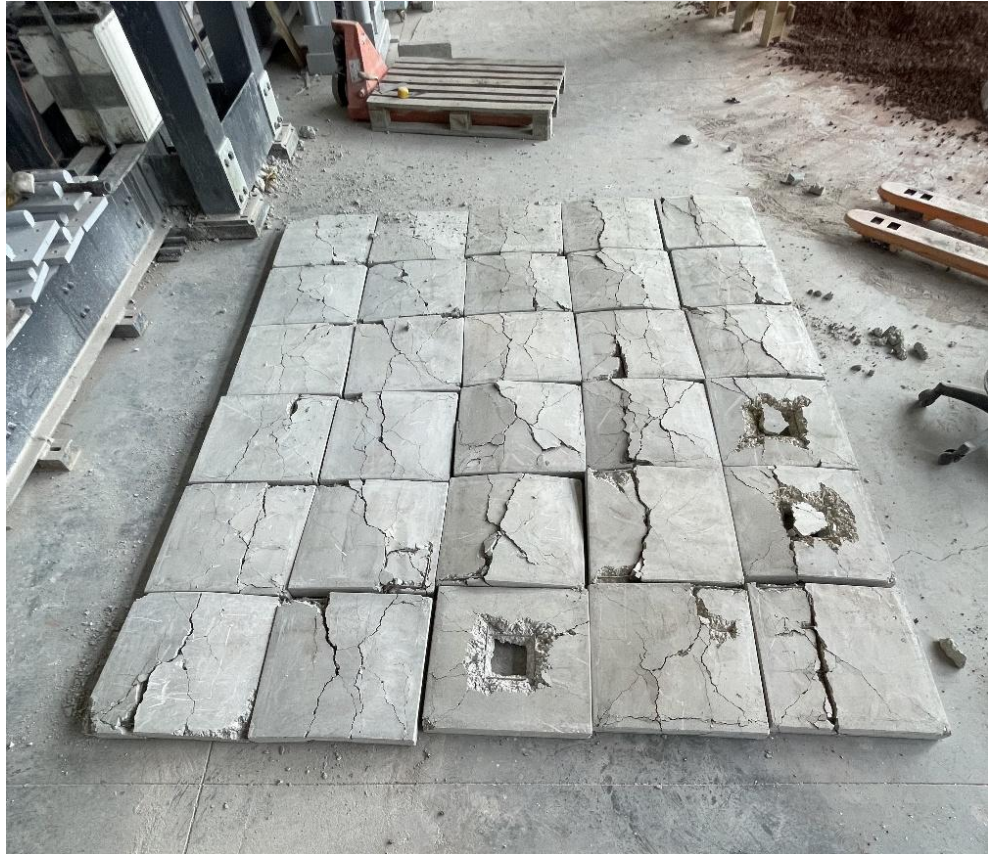
Şekil 4. 24. Eğilme deneyi sonrasında döşeme numunelerinin genel çatlak desenleri ve hasar dağılımı.
