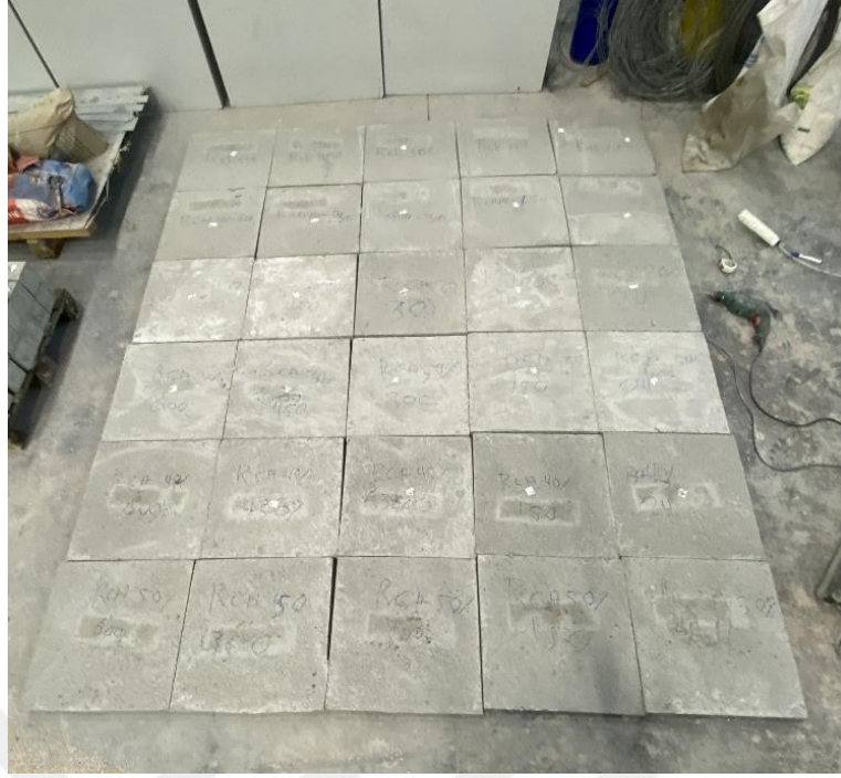
Şekil 3. 12. Deney programında kullanılan betonarme döşeme numuneleri
