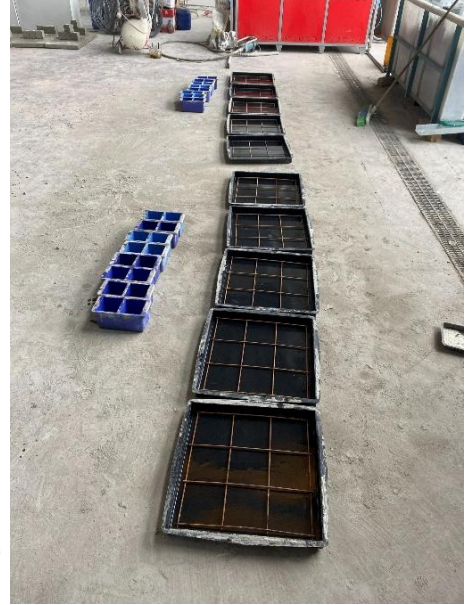
Şekil 3. 10. Döşeme numunelerine ait detaylar: (a) Donatı yerleşimi ve geometrik boyutlar, (b) Beton dökümü öncesinde kalıp içerisindeki donatı yerleşimi
