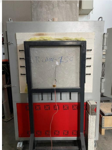
Şekil 3. 13. Döşeme numunelerinin tek yüzeyden ısıtılması için kullanılan deney düzeneği.
