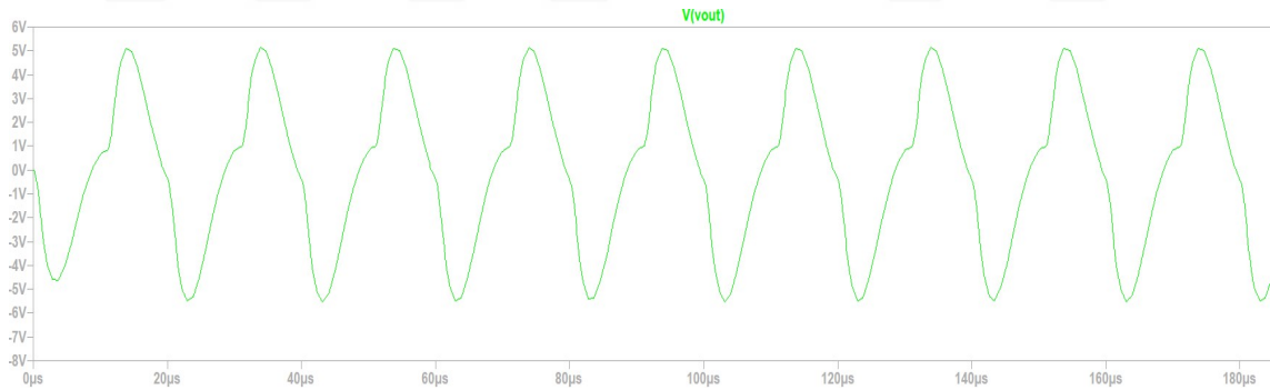
Şekil 3.41. Düşük frekans kare dalga uyarım verilmiş TIA için çıkış sinyali , LF347 ( C1=100\text{pF} , C2=2.2\text{pF} , R1=1\text{M}\Omega )
