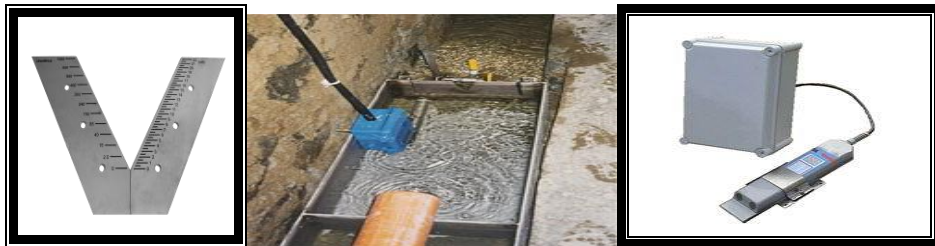
Şekil 4.10. V ağızlı savak ve debi ölçer cihazı örnekleri (URL-47)
