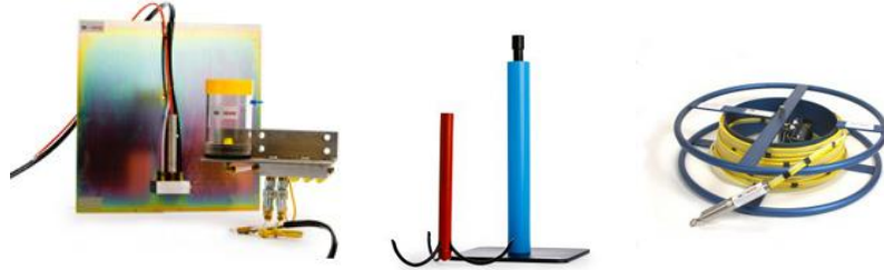
Şekil 4.6. Oturma ölçer örnekleri (soldan sağa: likit tipi, rod tipi, titreşim telli) (URL-44)
