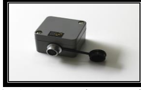
Şekil 4.14. Sismik ivmeölçer örneği (URL-51)
