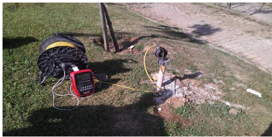
Şekil 4.5. İnklinometre cihazı örneği (URL-43)
