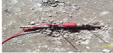
Şekil 4.11. Gerilme ölçer cihazı örneği (URL-40)
