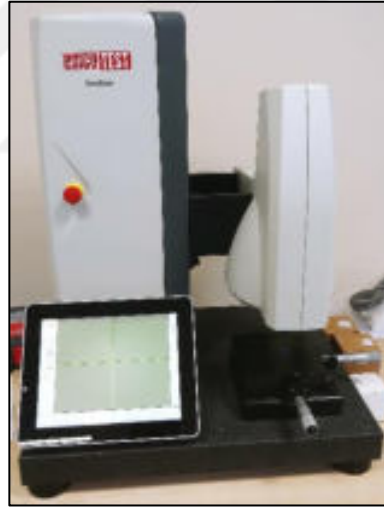
Şekil 3.12. Sertlik ölçümlerinin yapıldığı Emcotest-Durascan G5 vickers mikro sertlik cihazı
