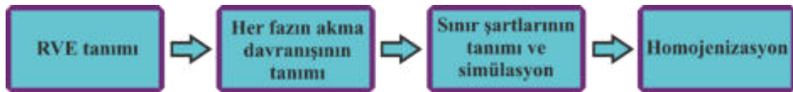
Şekil 2.14. Temsili hacim elemanı ile akma davranışının mikromekanik modellenmesinde işlem adımları
