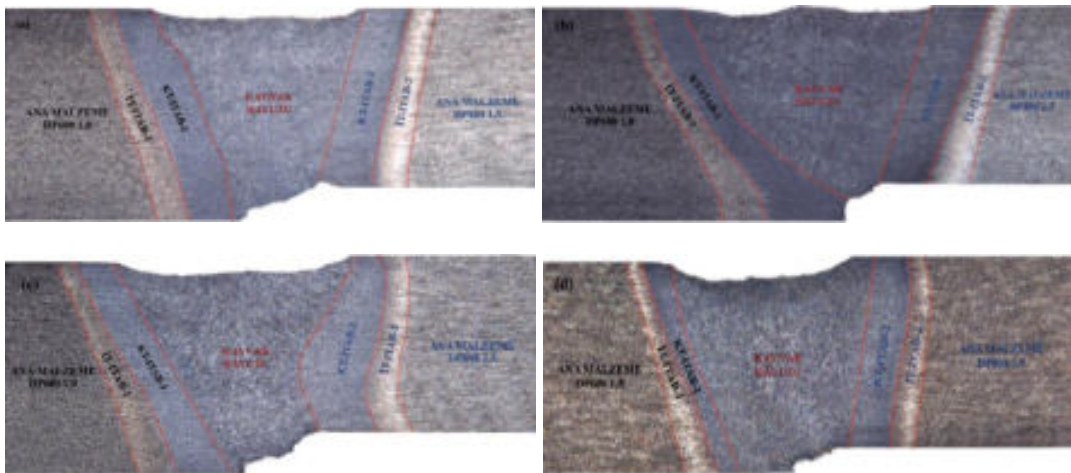
Şekil 4.2. TW1 sacının: (a) P2S3, (b) P2S4, (c) P3S3, (d) P3S4 parametrelerindeki makroyapı görüntüleri ve ısı tesiri altındaki bölgeleri
