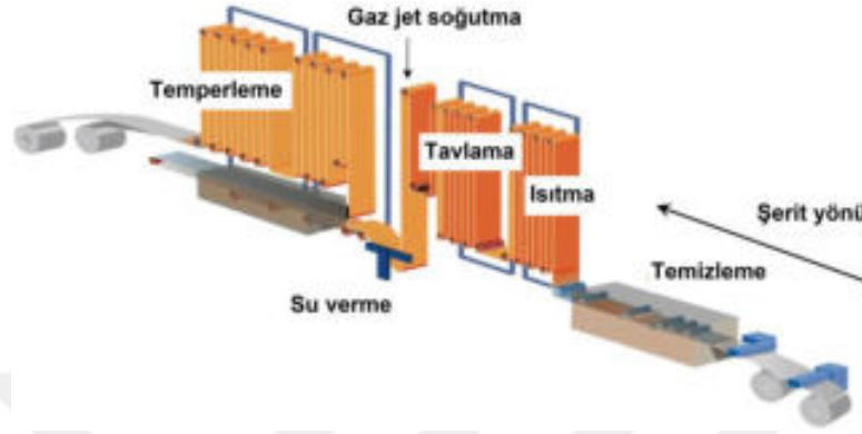
Şekil 2.6. SSAB'deki sürekli tavlama hattına ait şematik gösterim (Granbom, 2010)
