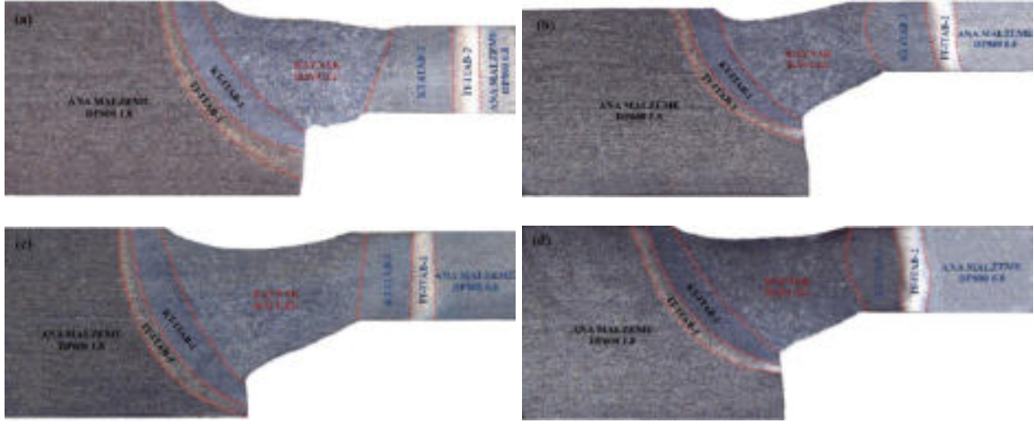
Şekil 4.3. TW2 sacının: (a) P2S3, (b) P2S4, (c) P3S3, (d) P3S4 parametrelerindeki makroyapı görüntüleri ve ısı tesiri altındaki bölgeleri
