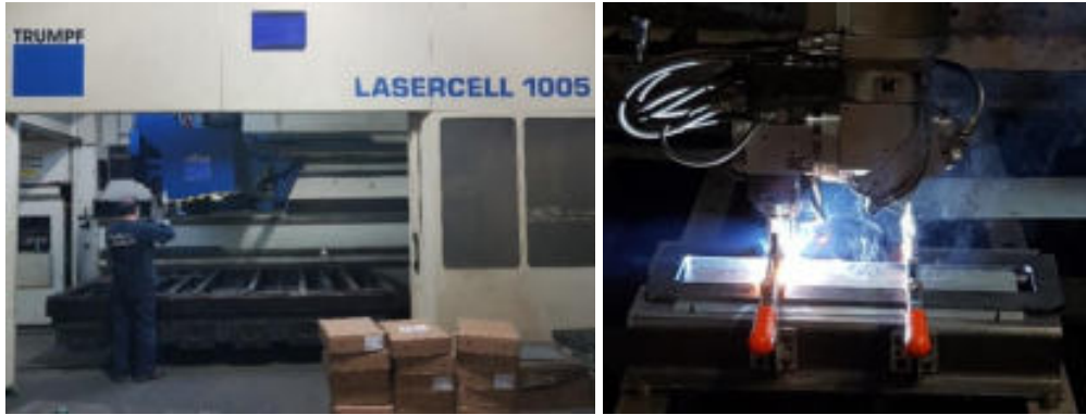
Şekil 3.5. Kaynak işlemlerinin gerçekleştirildiği CO 2 lazer tezgâhı ve iş parçalarının birleştirilmesi
