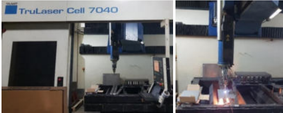
Şekil 3.4. İş parçası kesim işleminde kullanılan CO 2 lazer kesim tezgâhı ve kesim işlemi
