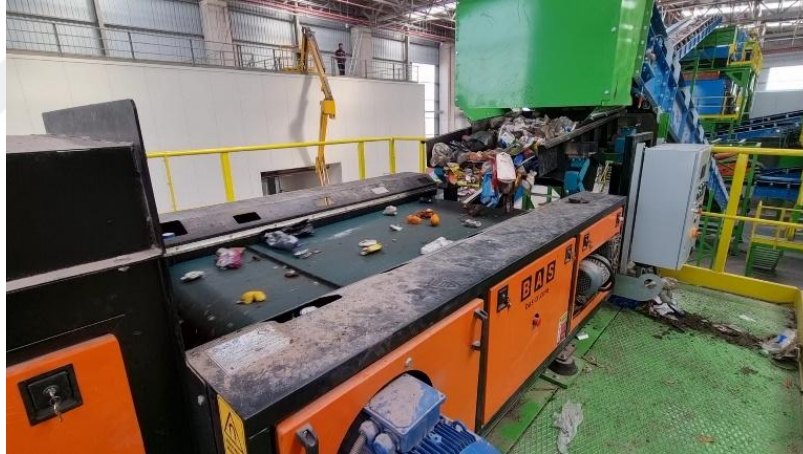
Şekil 1.13. Eddy Current Separator ile Ayırma (URL10)
