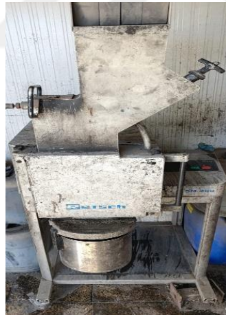
Şekil 3.4. Kırıcı/Öğütücü Cihazı (RETSCH SM 200)
