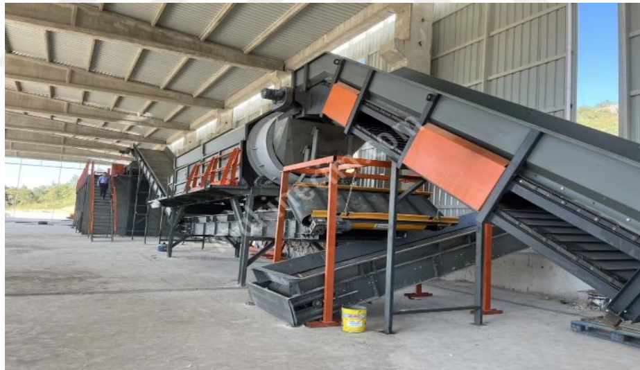
Şekil 1.15. Trommel Elek Sistemleri ile Ayırma (URL12)
