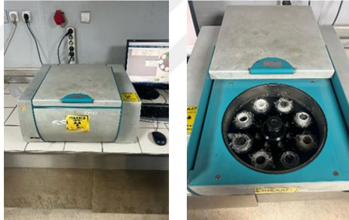
Şekil 3.2. Spectro Cihazı (AMETEI) ve Spectro Cihazı (AMETEI) Ölçüm Hazneleri
