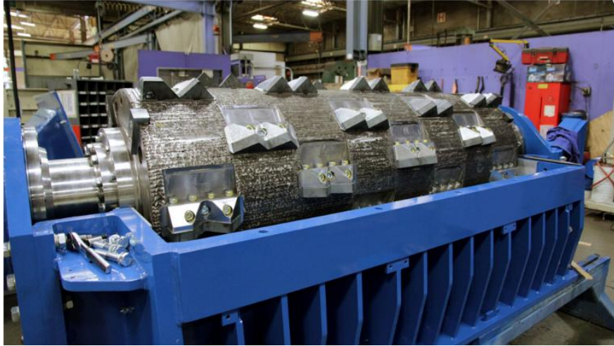
Şekil 1.30. SSI Shredding Systems SR900 Kırıcı Rotor Yapısı (URL19)
