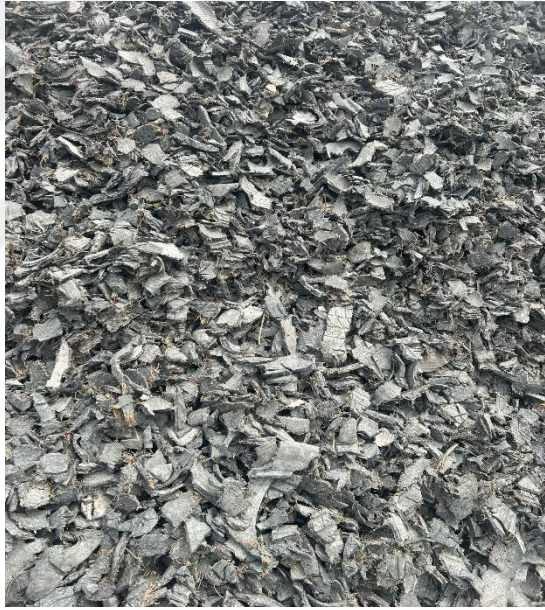
Şekil 1.10. Kıyılmış Lastik (Fırın beslemesine uygun hali)
