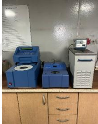
Şekil 3.1. Kalorimetre Cihazı (İKA WERKEN C 7000)
