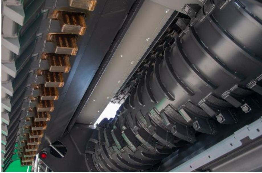
Şekil 1.27. Terminatör 5000 S Kırıcı Rotor Yapısı (URL18)
