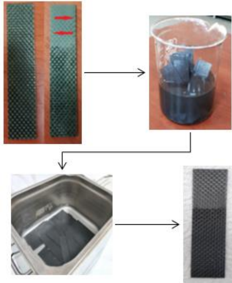
Şekil 3. 10. Kompozit plakaların yüzey hazırlığı işlemleri
