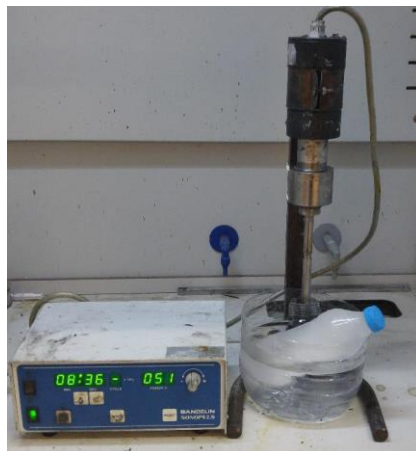
Şekil 3. 3. GNP katkılı N 6.6 çözeltisinin ultrasonik karıştırıcıda karıştırılması
