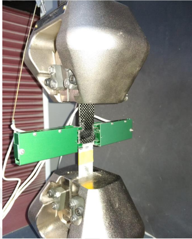
Şekil 3. 24. Ekstansiyometrenin deney numunesine bağlanması
