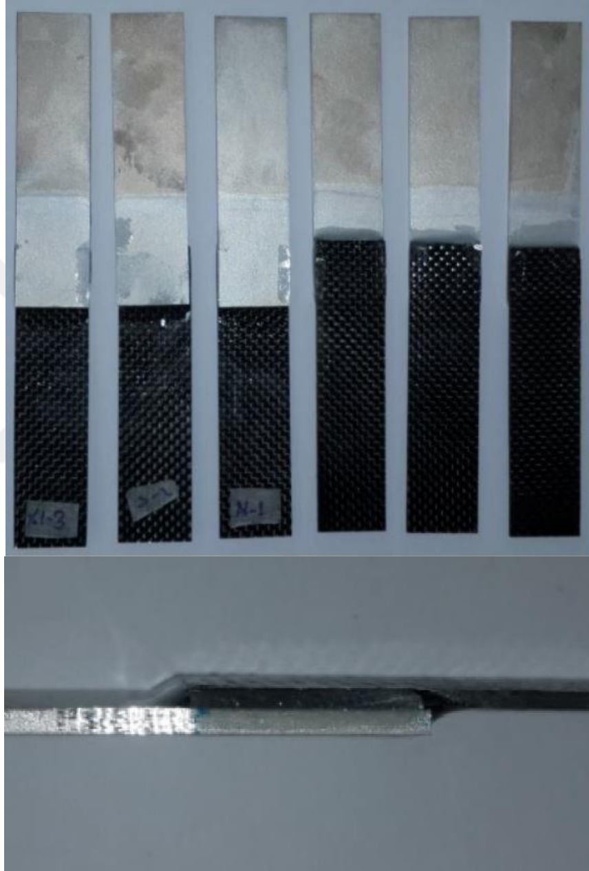
řekil 3. 14. Alminyum-kompozit tek taraflı yapışma bağlantıları
