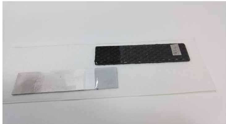
Şekil 3. 11. Epoksi yapıştırıcının yapışma bölgelerine sürülmesi
