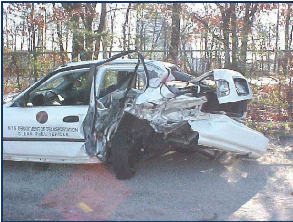
Şekil 1.22. CNG tankının patlaması sonucunda araçta meydana gelen hasarı gösterir görsel (Atagün, 2017)
