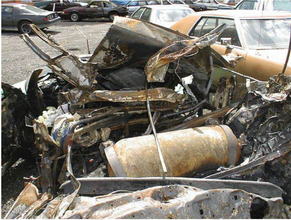
Şekil 1.21. Çelik tankın patlaması sonucu aracın görüntüsü (Atagün, 2017)
