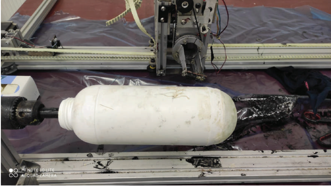
Şekil 3.5. Sarım öncesi makineye bağlanmış basınçlı kabın (liner) görüntüsü
