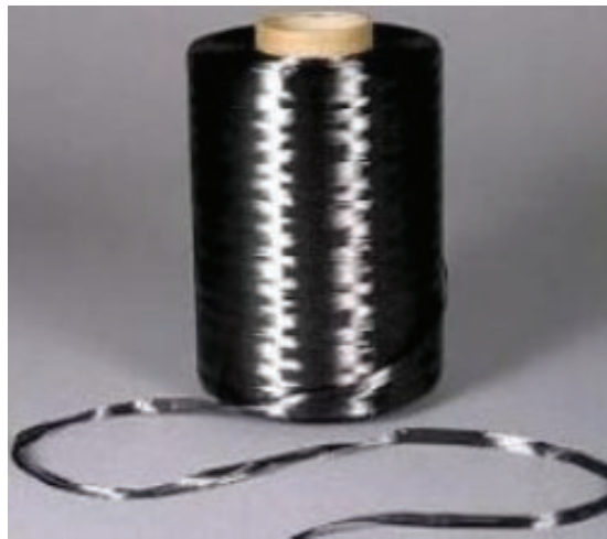
Şekil 3.1. Karbon elyaf ip 24K
