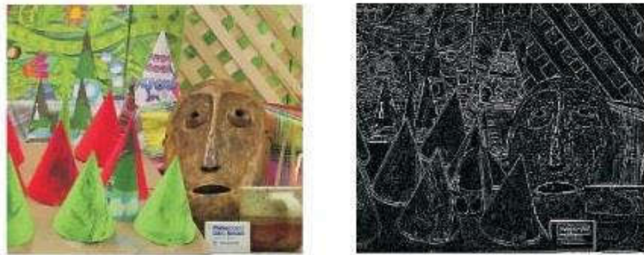
Şekil 3.11. Görüntü Gradyanı Uygulanmış Fotoğraf (Orijinal Görüntü(Sol), İşlenmiş Görüntü(Sağ))
