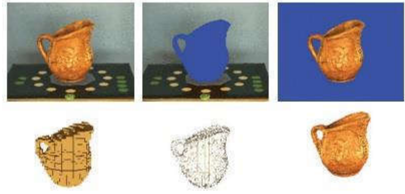
Şekil 3.15. SFS ile Elde Edilmiş 3B Model ve İyileştirmeleri
