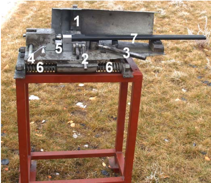
Resim 1. Profil ayaklar üzerine oturtulmuş atış düzeneği. 1. Emniyet kapağı, 2. Emniyet kapağı kilitleme kolu, 3. Namlu sabitleme kolu, 4. Ateşleme kolu, 5. Perkütör, 6. Yay düzeneği, 7. Namlu.
