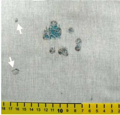
Resim 7. 3 m mesafeden tapa parçalarının hedefte oluşturduğu delikler
