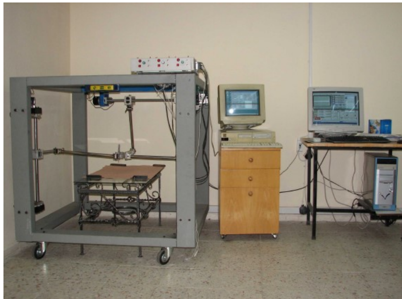
Şekil 3.6. Kartezyen Robot Tasarımı
