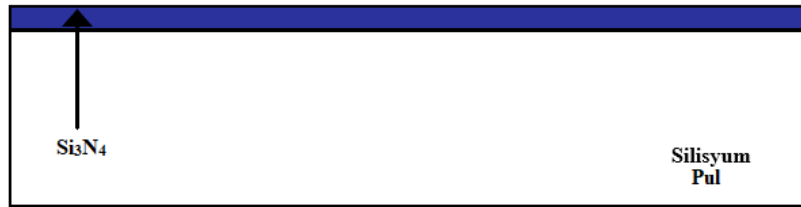
(a) Manyetik alan saçtırma ile Si_3N_4 yalıtkan tabaka kaplanır.
