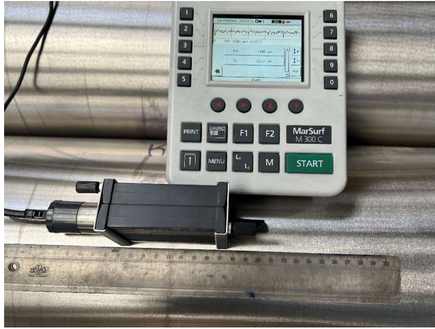
Şekil 4.5. Rulmanlı yataklama ile taşlanan vals topunun orta kısımdaki yüzey pürüzlülük değeri 1,14 \mu\text{m} (Yenar Döküm San., 2022)
