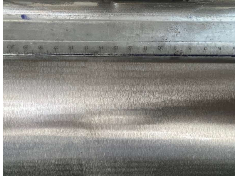
Şekil 4.9. Rulmanlı yataklama ile taşlanan başka bir vals topunun orta kısmındaki titreşimden dolayı oluşan yüzey bozukluğu (Yenar Döküm San., 2022)
