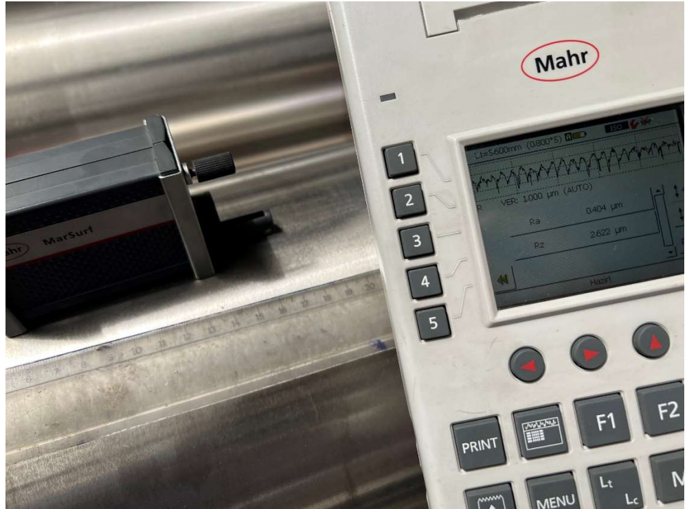
Şekil 4.15. Hidrodinamik kaymalı yataklama ile taşlanan vals topunun sol bölümünden 100 mm ötesinde yüzey pürüzlülük değerleri 0.373 µm okunmuştur. (Yenar Döküm San., 2022)
