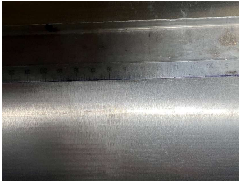
řekil 4.8. Rulmanlı yataklama ile tařlanan vals topunun yzeyinde okgenlerin oluřması ve silindiriklik yapının bozukluęu (Yenar Dkm San., 2022)
