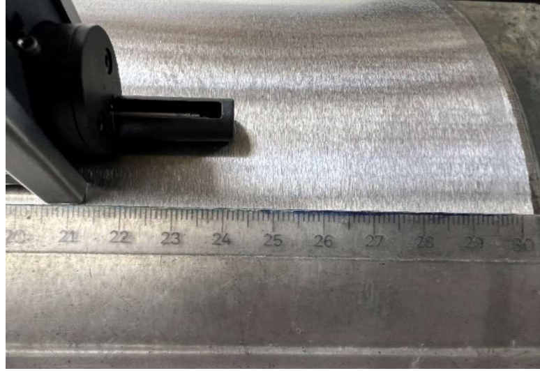
Şekil 4.3. Rulmanlı yataklama ile taşlanan vals topunun yüzey kalitesi (Yenar Döküm San., 2022)
