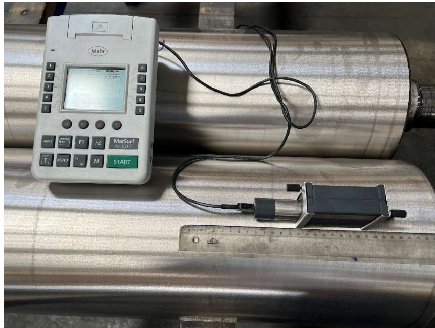
Şekil 4.5. Rulmanlı yataklama ile taşlanan vals topunun orta kısımdaki yüzey pürüzlülük değeri 1,14 \mu\text{m} (Yenar Döküm San., 2022)
