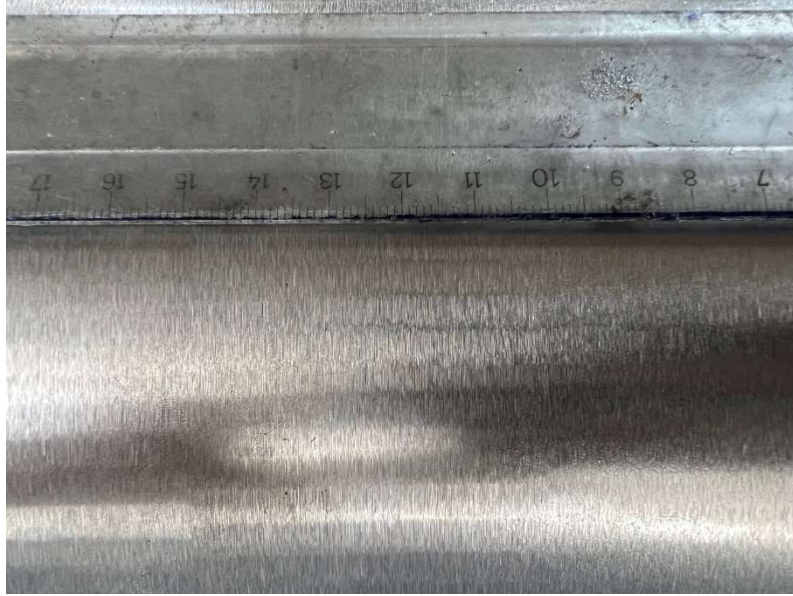
řekil 4.7. Rulmanlı yataklama ile tařlanan vals topunun sol taraftan 430 mm tedeki blgesinde titreřimden dolayı oluřan yzey bozukluęu (Yenar Dkm San., 2022)
