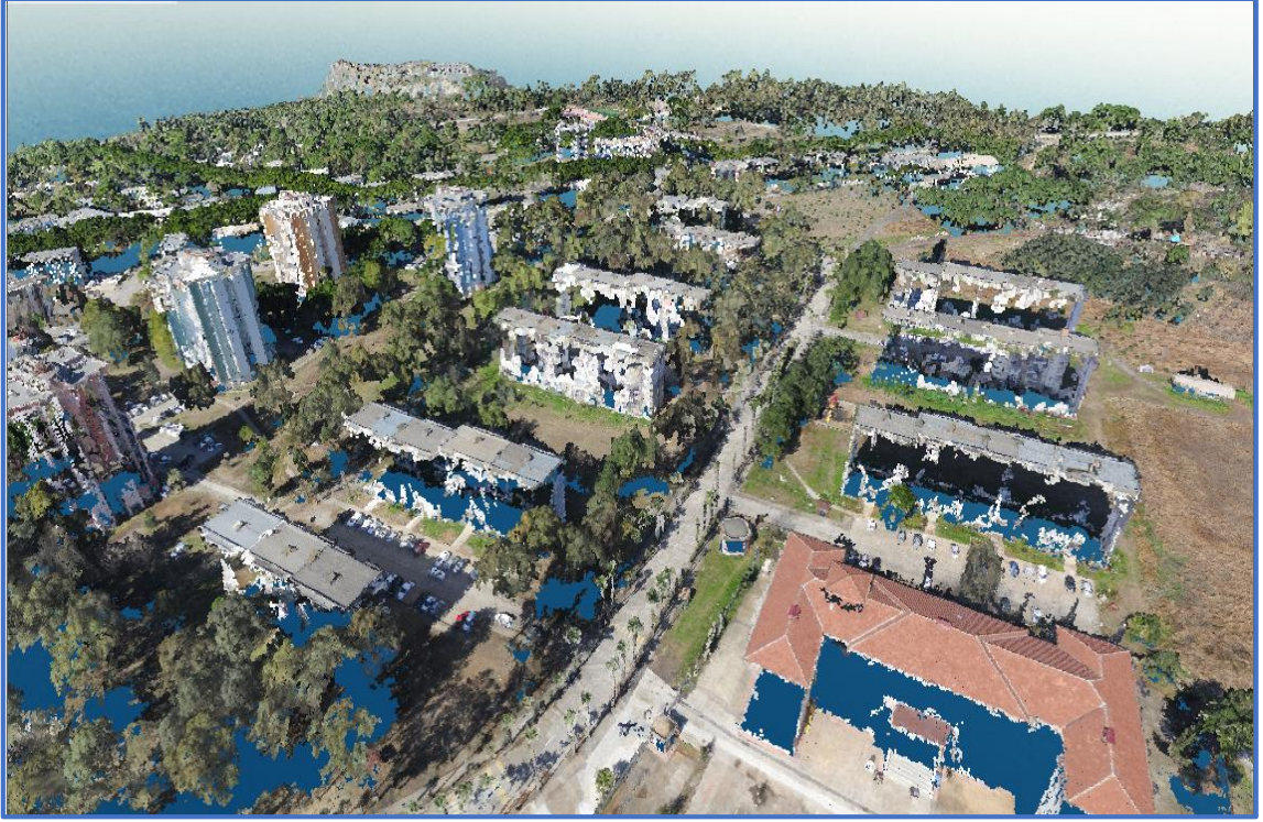
Şekil 4.16. Nadir Fotoğraflarla Elde Edilen Nokta Bulutu
