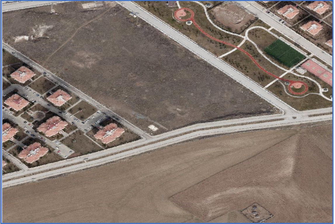
Şekil 4.17. Tüm Yönlerdeki Fotoğraflarla Elde Edilen Nokta Bulutu
