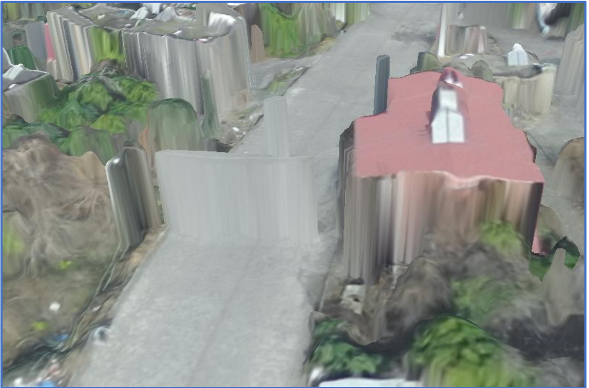
Şekil 4.22. SYM'lerde Tel vb. Engellerden Dolayı Meydana Gelen Hatalar
