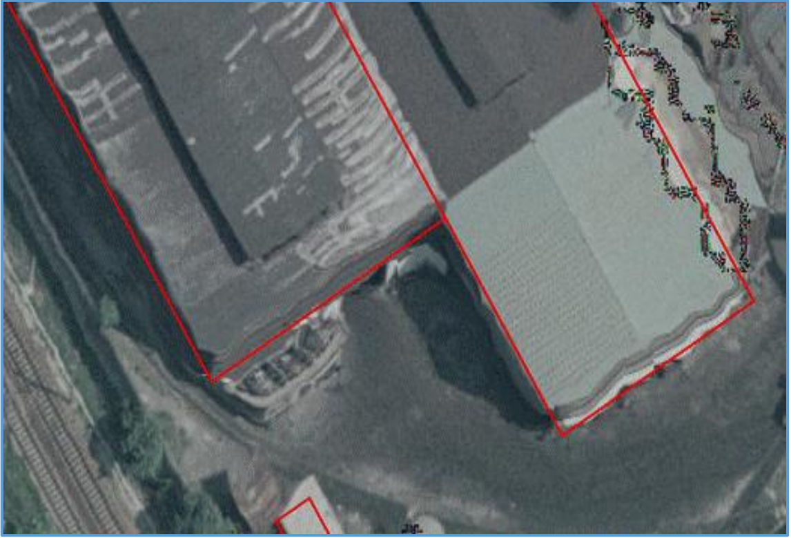
Şekil 4.27. Ortofotoda Bina Kenarlarında Meydana Gelen Eğrilikler ve Hatalar
