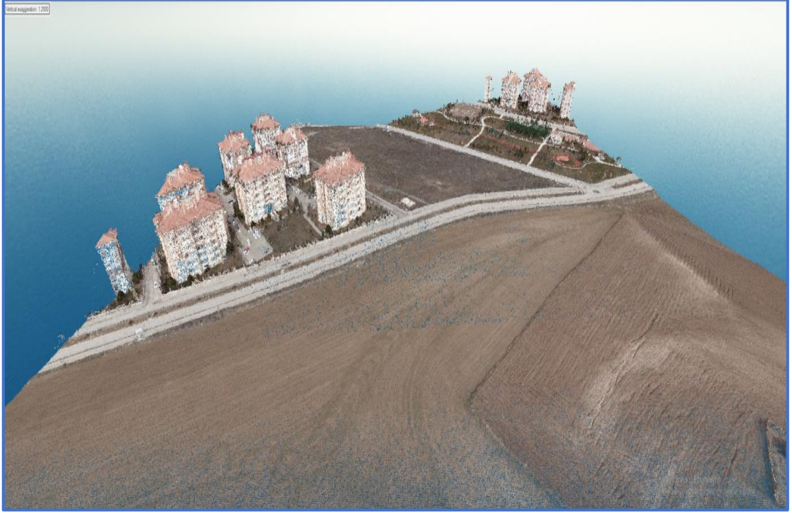
Şekil 4.18. Tüm Yönlerdeki Fotoğraflarla Elde Edilen Nokta Bulutu
