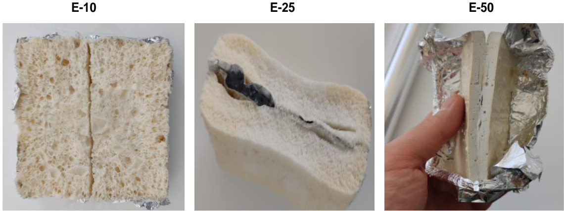
Şekil 4. 2. Farklı sertlik değerlerine sahip RTV-2 polimerlerin köpürtülmesi
