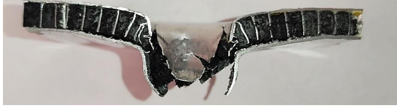
Şekil 4. 42. Hücre boyutu 5.2 mm folyo kalınlığı 50 µm ve çekirdek yüksekliği 8 mm olan dolgulu alüminyum bal peteği sandviç düzlem dışı makro indentasyon sonrasında panelin kesit görüntüsü
