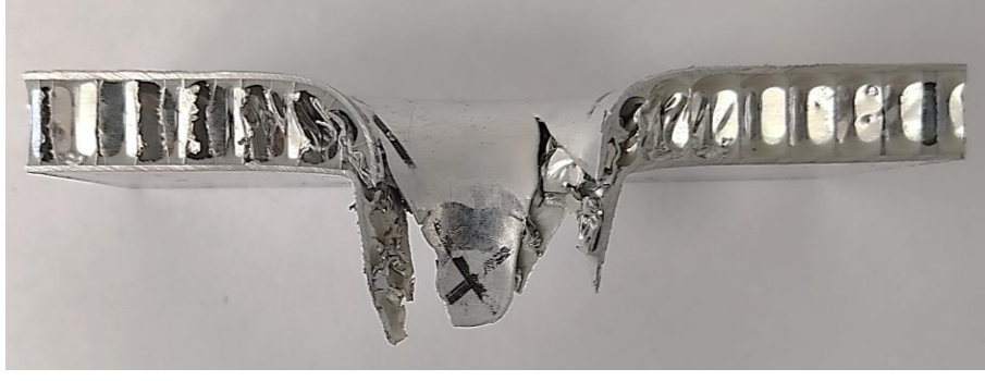
Şekil 4.38. Hücresi boyutu 5.2 mm folyo kalınlığı 50 µm ve çekirdek yüksekliği 8 mm olan dolgunsuz alüminyum bal peteği sandviç düzlem dışı makro indentasyon sonrasında panelin kesit görüntüsü
