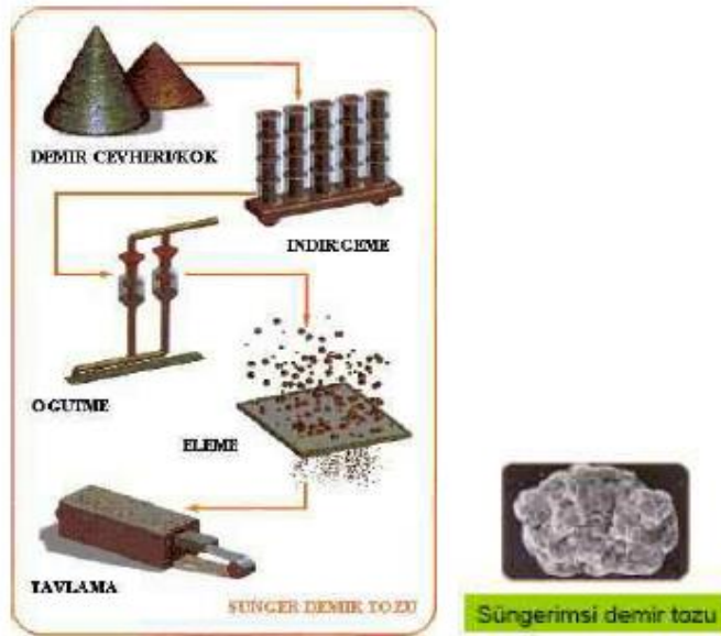
Şekil 2. 4. Kimyasal yöntemle demir tozu üretimi[38]
