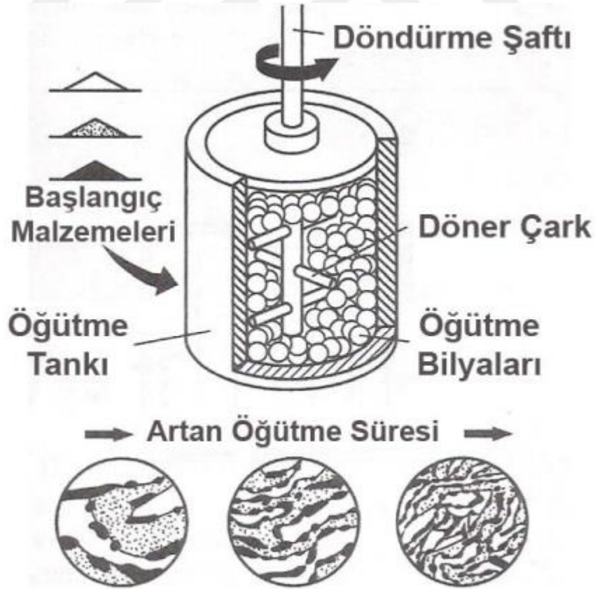
Şekil 2. 7. Öğütücü tank ve şematik görünümü[40]
