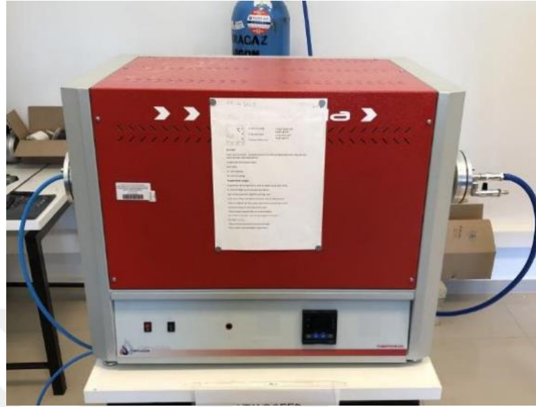
Şekil 6.8. Atmosfer kontrollü Nevola marka sinterleme fırını
