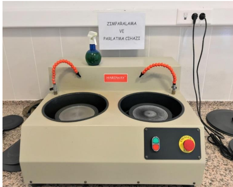
Şekil 6.10. Hardway marka çift diskli zımparalama ve parlatma cihazı
