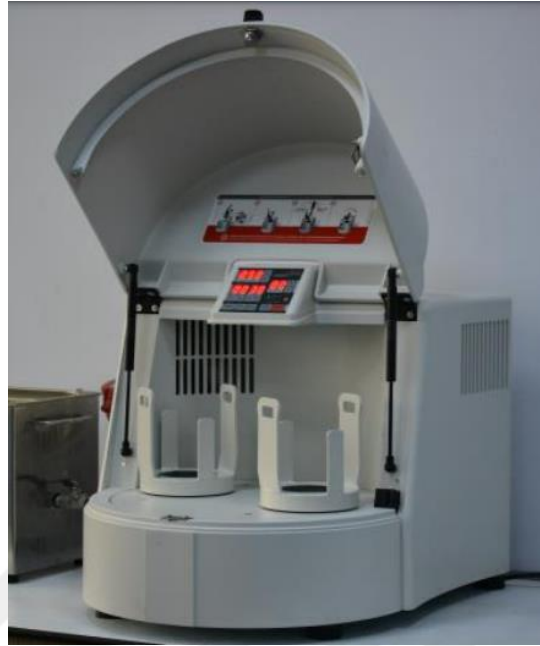
Şekil 6.6.Fritsch Pulverisette 5 marka gezegen tipi karıştırıcı
