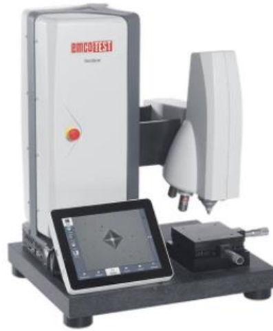
Şekil 6.13. Emcotest marka (Brinell) sertlik ölçüm cihazı
