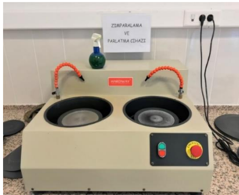
Şekil 6.12. Çift Diskli Hardway marka zımparalama ve parlatma cihazı
