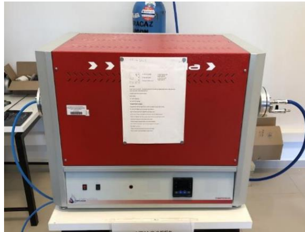
Şekil 6.9.Nevola marka atmosfer kontrollü sinterleme fırını
