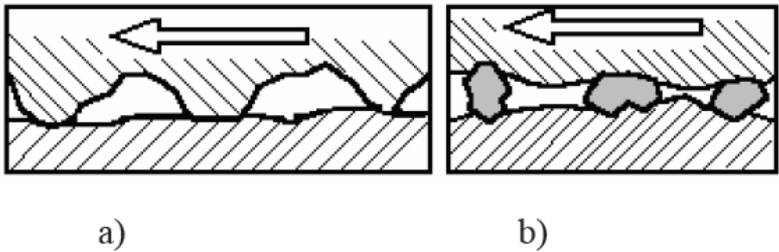
Şekil 4.4. Abrasif aşınma mekanizmaları; a) iki elemanlı ve b) üç elemanlı aşınma [35]
