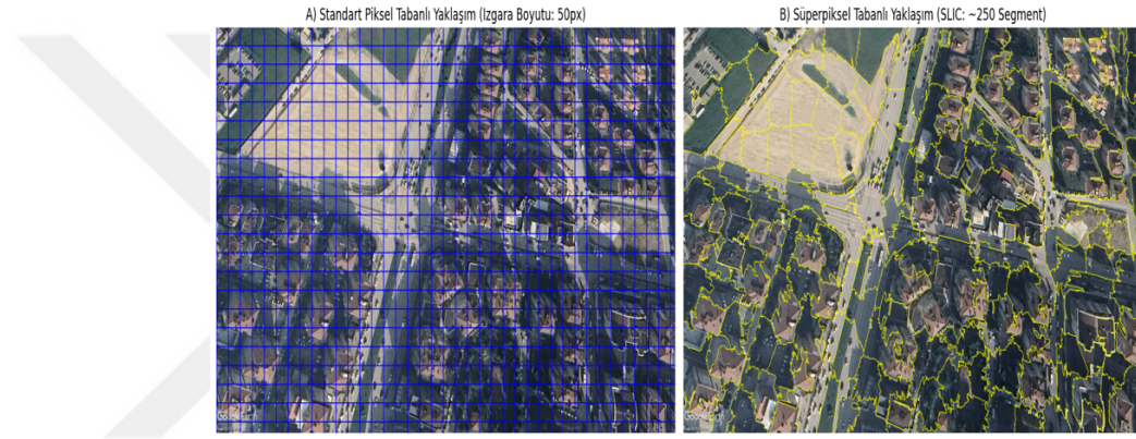
Şekil 2.10. Geleneksel piksel tabanlı ızgara ile SLIC süperpiksel bölütleme sınır doğruluğunun Google Earth üzerinde karşılaştırılması
