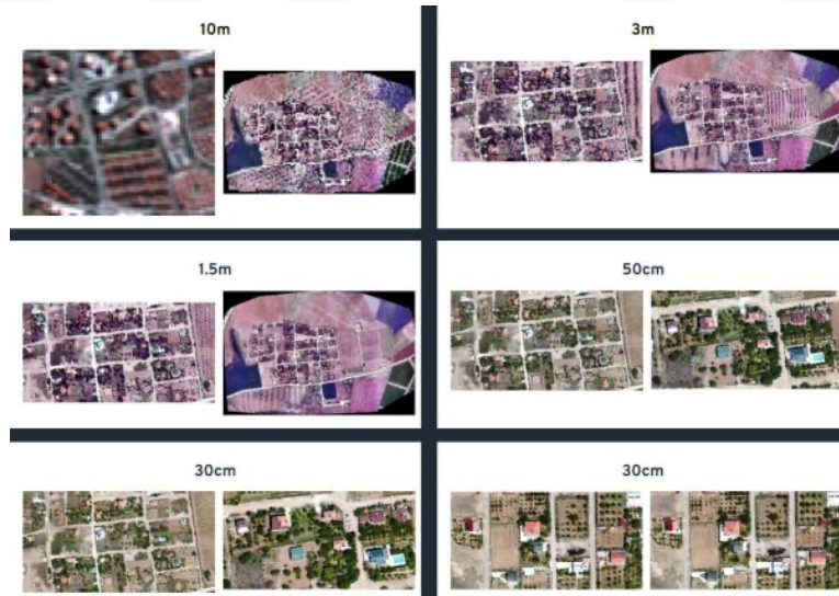
Şekil 2.2. Farklı piksel boyutlarının (GSD) görüntü detayı üzerindeki etkisi (“Mekânsal Çözünürlük Nedir?”, 2023)
