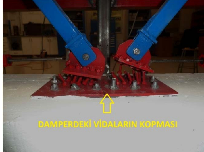
Şekil 4.38. Damperdeki vidaların kopması nedeniyle deneyin sonlandırılması
