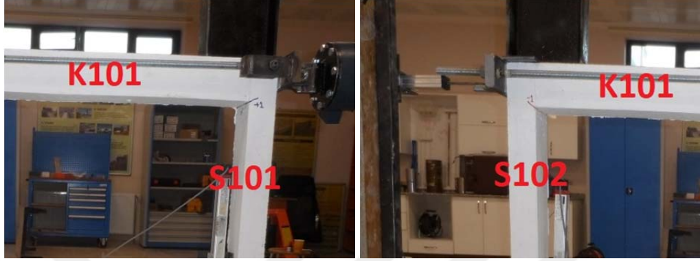
Şekil 4.5. Deney numunesi 1'de, itme ve çekme çevrimlerinde oluşan ilk çatlaklar
