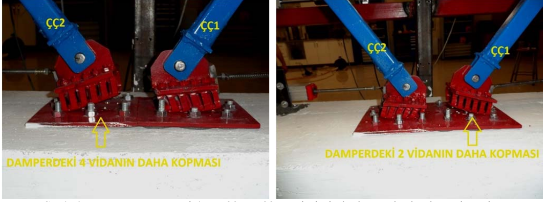
Şekil 4.55. Deney numunesi 4'te +22 ve -22 çevrimlerinde damperlerde oluşan hasarlar
