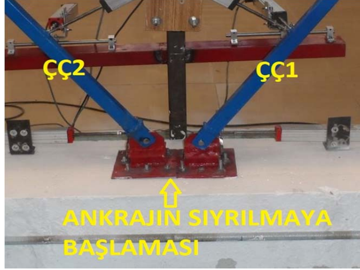
Şekil 4.17. Ankrajın sıyrılmaya başlaması
