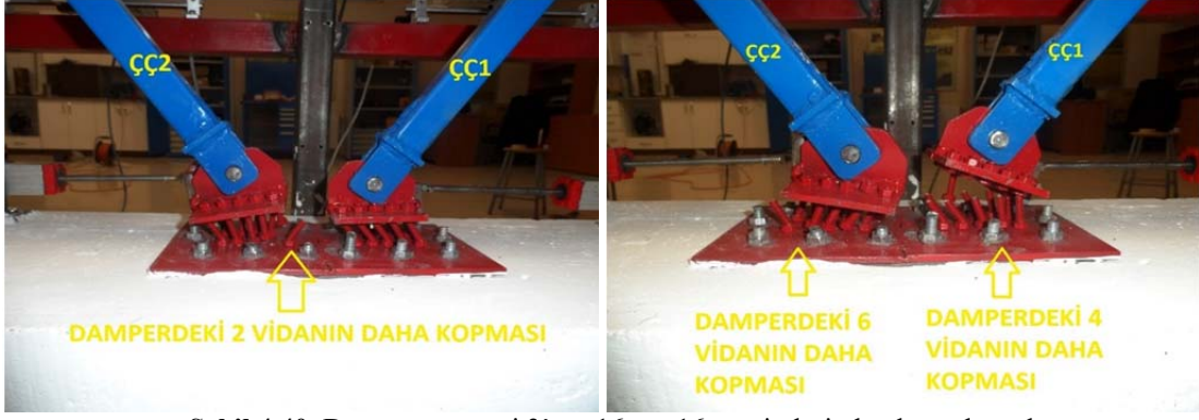
Şekil 4.40. Deney numunesi 3'te +16 ve -16 çevrimlerinde oluşan hasarlar
