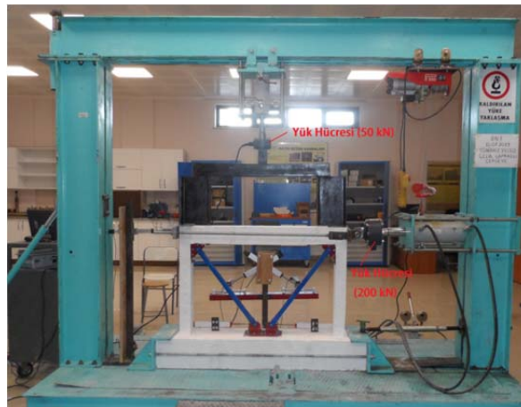
Şekil 3.8. Deneylerde kullanılan yük hücrelerinin sistemdeki yerleri
