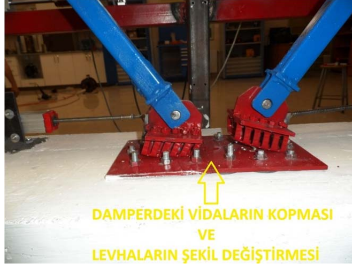
Şekil 4.53. Damperdeki vidaların kopması ve levhaların şekil değiştirmesi nedeniyle deneyin sonlandırılması
