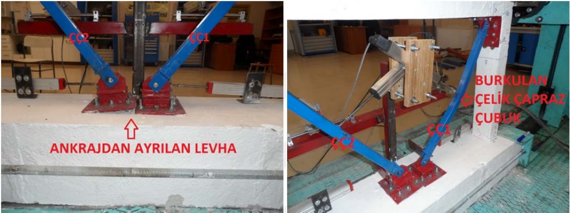
Şekil 4.30. Deney numunesi 2'nin, göçme konumunda çelik çapraz ve sönümleyicide oluşan hasarlar Deney numunesi 2'de; deney sonunda oluşan hasarlar Şekil 4.31'de verilmiştir.
