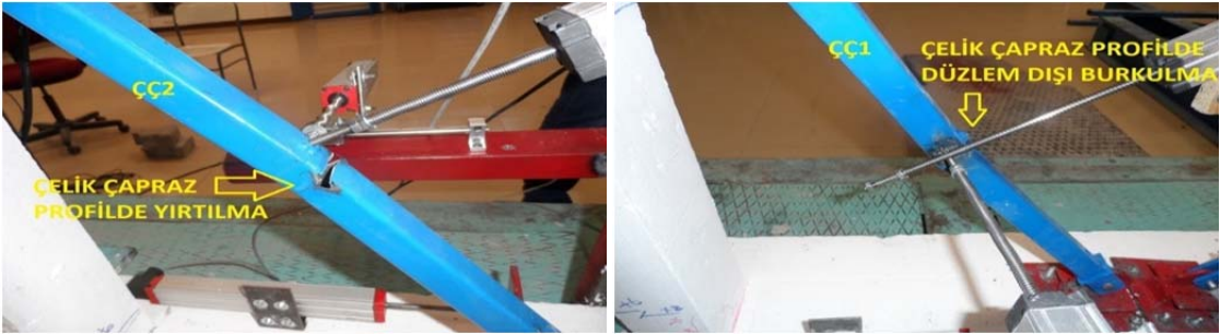
Şekil 4.30. Deney numunesi 2'nin, göçme konumunda çelik çapraz ve sönümleyicide oluşan hasarlar Deney numunesi 2'de; deney sonunda oluşan hasarlar Şekil 4.31'de verilmiştir.
