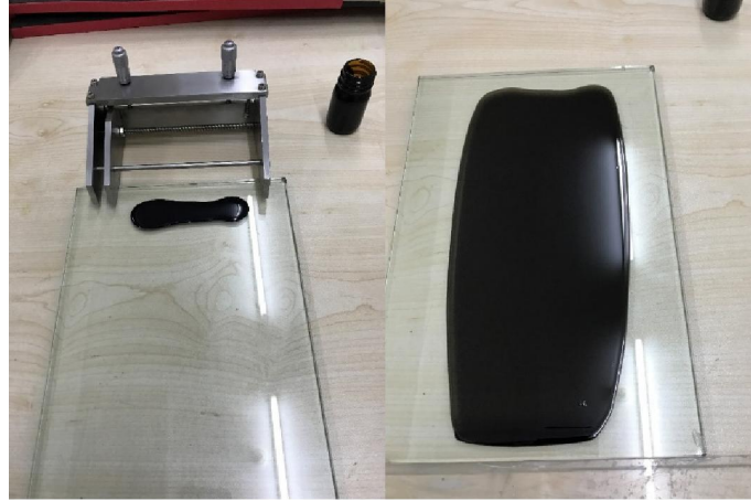
Şekil 3.2. Membranın cam üzerine dökülmesi.
