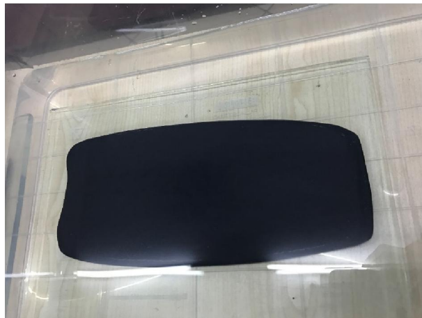
Şekil 3.3. Çöktürme (su) banyosuna daldırılan membran.
