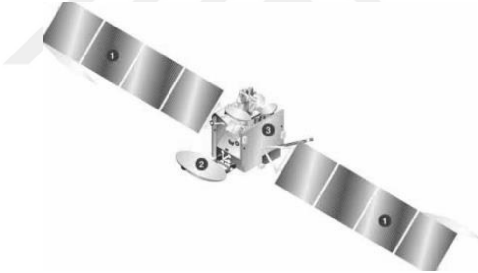
Şekil 1.35 Bal peteği sandviç yapının uyduda kullanıldığı parçalar (Hexcell 2007)
