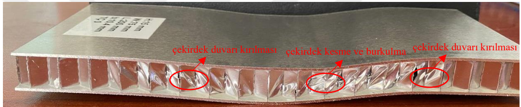
Şekil 4.22 H15/B10,4/TÇ0 deney parçasında oluşan hasar türleri
