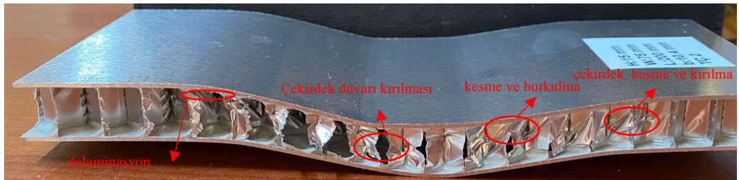
Şekil 4.30 H15/ B10,4/TÇ2 deney parçasında oluşan hasar türleri
