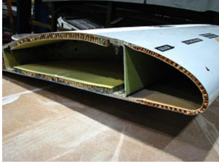
Şekil 1.32 Bal peteği sandviç yapıdan imal edilmiş uçak kanadı
