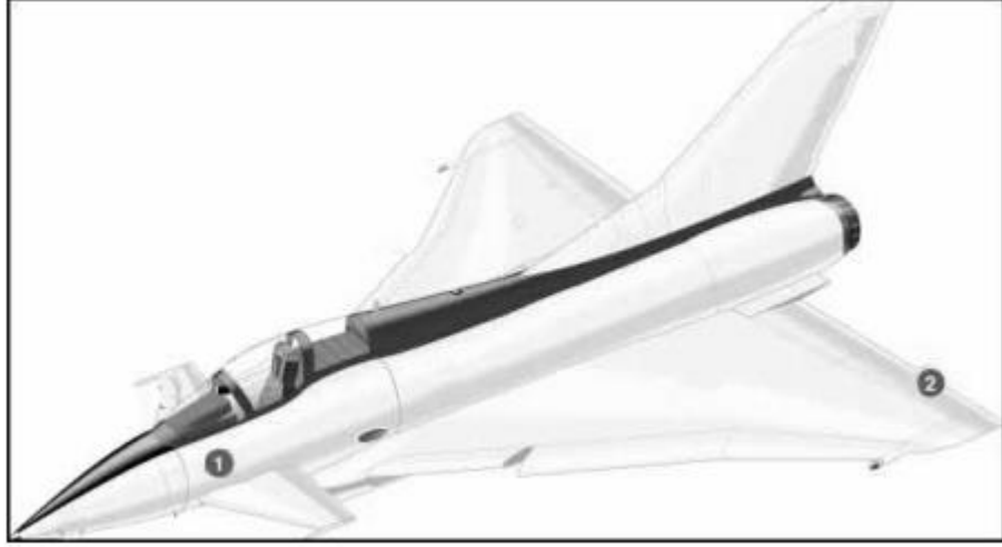
Şekil 1.34 Bal peteği sandviç yapının uçakta kullanıldığı parçalar (Hexcell 2007)
