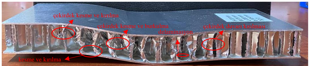
Şekil 4.31 H20/ B10,4/TÇ2 deney parçasında oluşan hasar türleri
