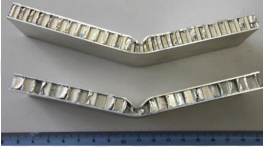
Şekil 2.6 Eğilme testi sonrası malzemede hasar mekanizması (Crupi ve ark. 2012)
