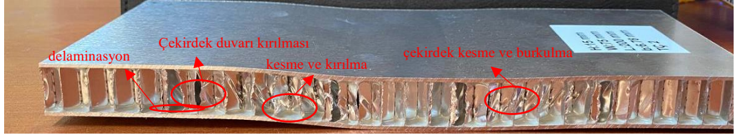
Şekil 4.28 H15/B6,78/TÇ2 deney parçasında oluşan hasar türleri
