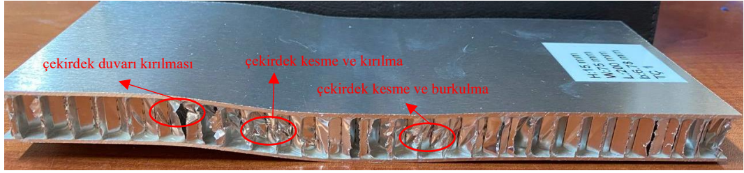
Şekil 4.24 H15/B6,78/TÇ1 deney parçasında oluşan hasar türleri
