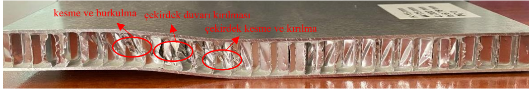
Şekil 4.20 H15/B6,78/TÇ0 deney parçasında oluşan hasar türleri
