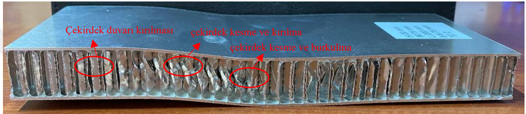
Şekil 4.29 H20/ B6,78/TÇ2 deney parçasında oluşan hasar türleri
