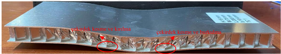
Şekil 4.26 H15/B10,4/TÇ1 deney parçasında oluşan hasar türleri
