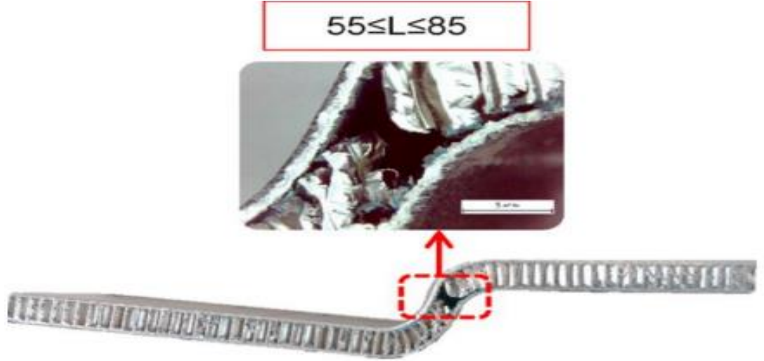
Şekil 2.8 Malzemedeki meydana gelen hasarlar (Palomba, 2019)
