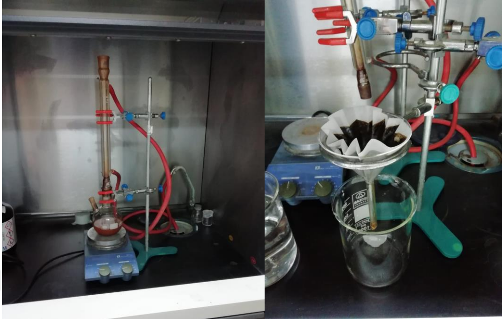
Şekil 3.2. Magnetik nanopartikül sentez düzeneği
