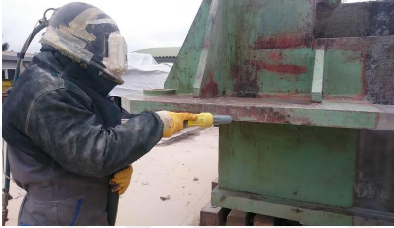
Şekil 3.1. Boyama öncesi kumlama işlemi yapılan bir iş parçası
