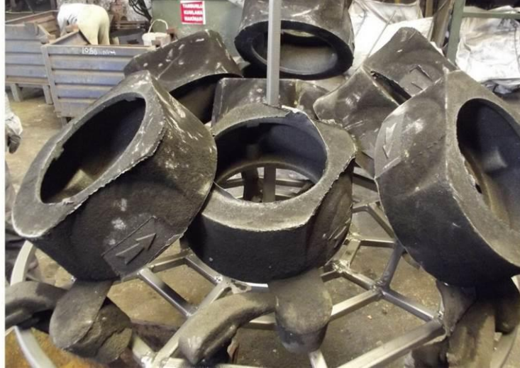
Şekil 3.5. Kumlama yöntemi ile yüzey pürüzlülüğü homojenleştirilir
