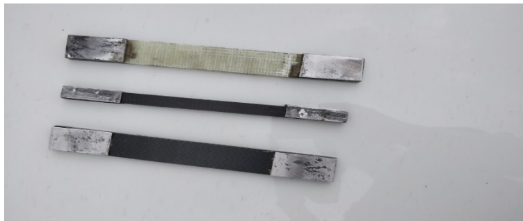
Şekil- 4: Standartlarda Hazırlanmış Çekme Deneyi Malzemeleri
