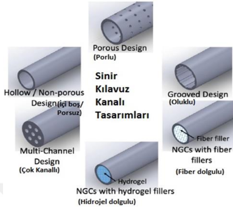
Şekil 2.22. Farklı sinir kılavuz kanalı tasarımları (Vijayavenkataraman 2020)
