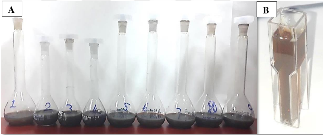
Şekil 3.3. A) UV-vis spektrofotometre analizi için hazırlanan 24 saat bekletilmiş kekik ekstraktı/ \text{AgNO}_3 çözeltileri B) 24 saat sonra gözlenen renk değişimi
