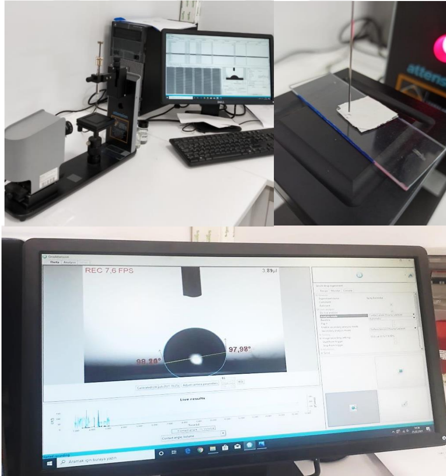
Şekil 3.6. Su-temas açısı ölçümü
