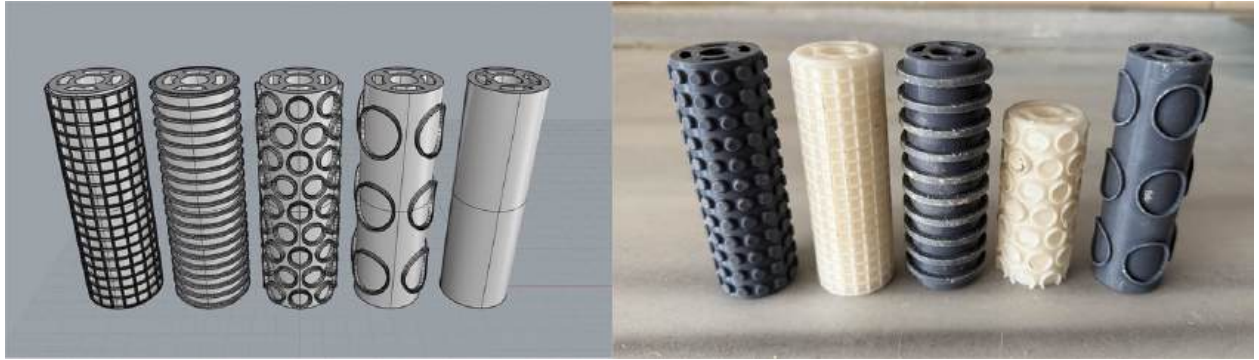
Şekil 3.15. Rhino 3D Programında Tasarlanan Silindirik Mühürler ve 3D Yazıcı ile Üretilmesi.
