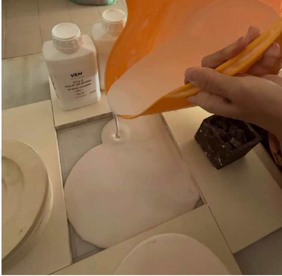
Şekil 3.1. Alçı Plakanın Dökülmesi.
