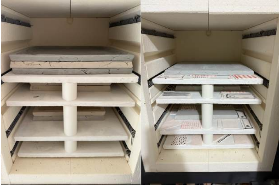
Şekil 3.19. 980°C Bisküvi Pişirim Aşaması
