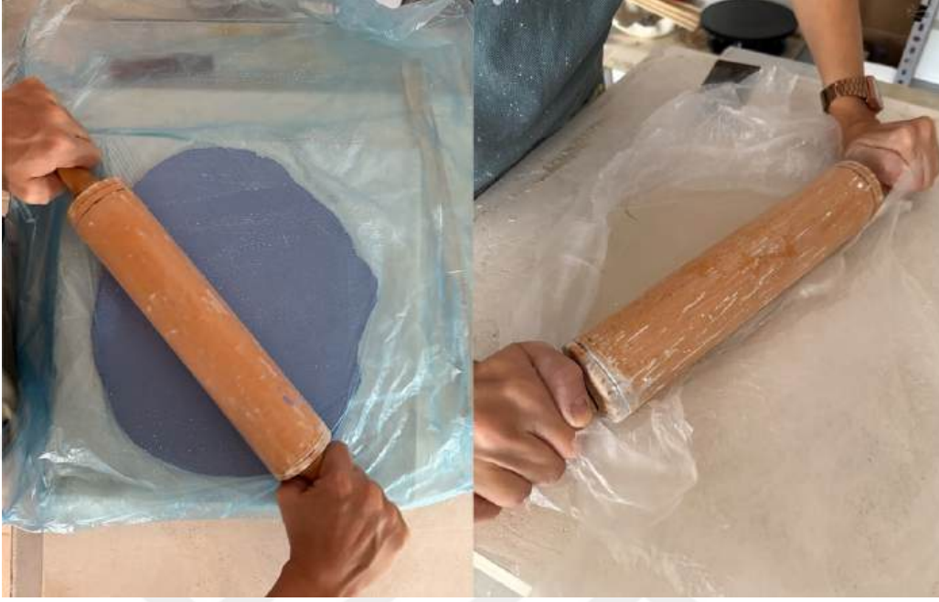
Şekil 3.8. Kâğıt Katkılı Killerin İnce Plakalar Halinde Açılması.
