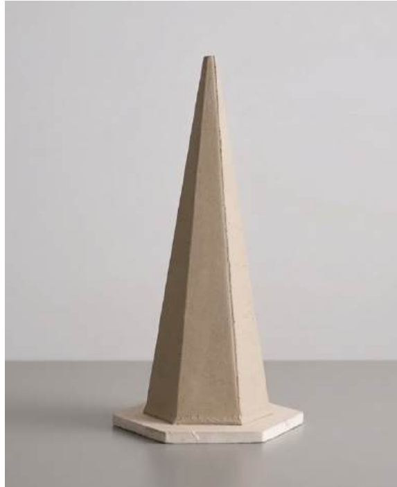
Şekil 3.57. Altıgen Piramit Seramik Formun Rötüş İşlemlerinin Tamamlanması.
