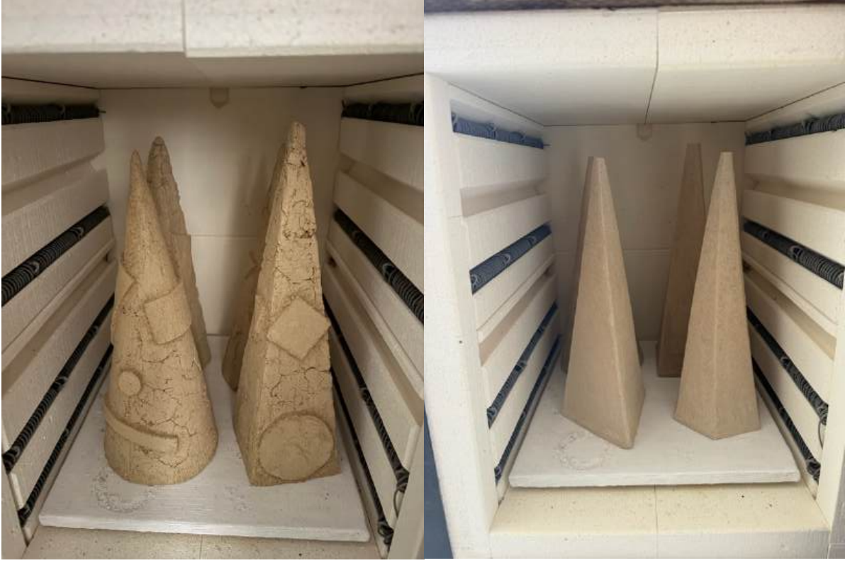
Şekil 3.58. Seramik Heykellerin Bisküvi Pişirim Aşaması.
