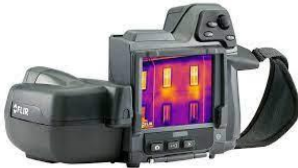
Şekil 3.10. Flir T termal kamera seti (Flir T, 2023)
