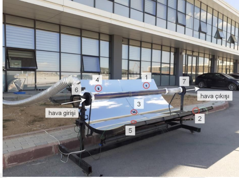
Şekil 3.1. Parabolik oluklu güneş kolektörünün deneysel kurulumu
