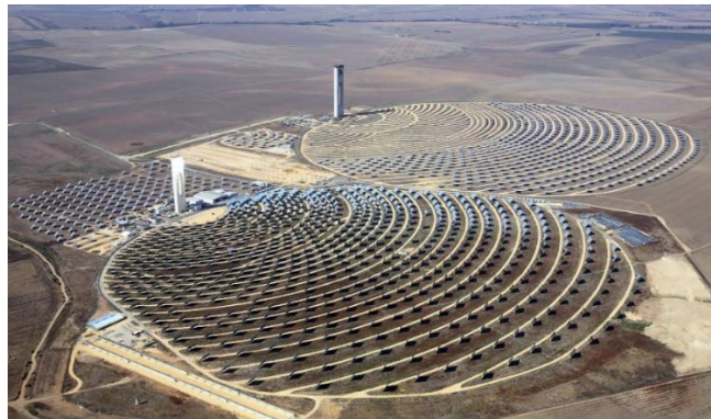
Şekil 1.6. Merkezi güneş kulesi sistemleri (Özcan, 2021)
