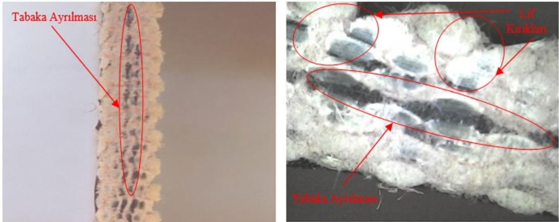
Şekil 64. %0.5 KNT ve %0.5 Zirkonya'nın 15 J darbe enerjisindeki hasar mekanizmaları
