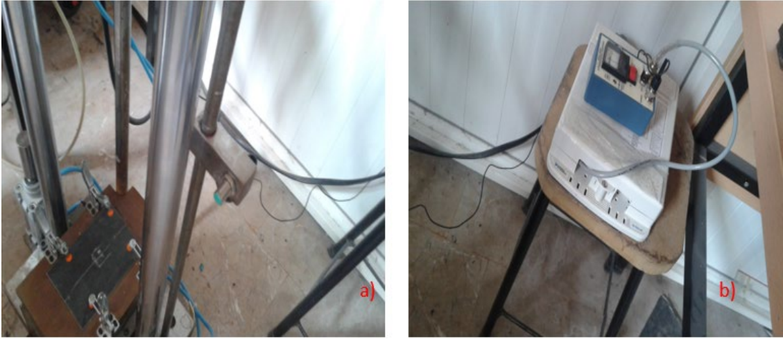
Şekil 10. a) Konum sensörü b) Sinyal şartlandırıcı ve veri toplayıcı
