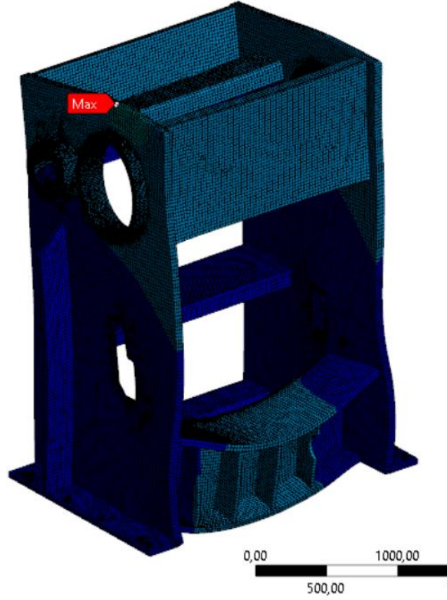
Şekil 4.45 Pres gövdesi sonlu elemanlar modeli deformasyon dağılımı
