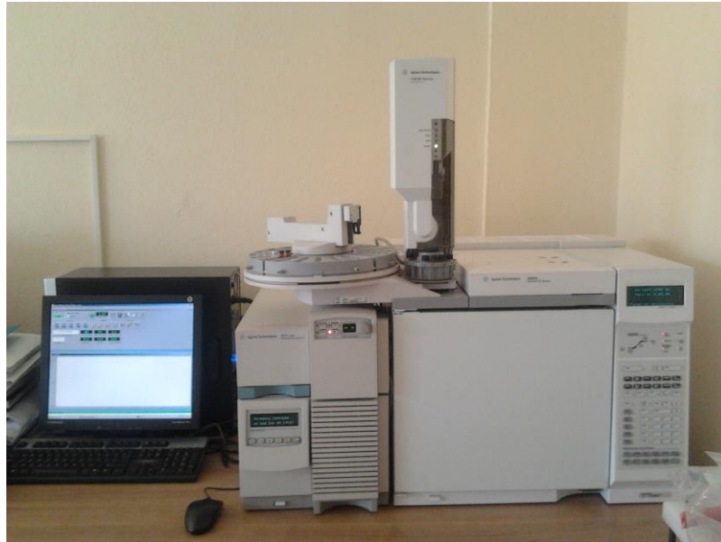
Şekil 3.15. Analizlerin yapıldığı GC-MS cihazı
