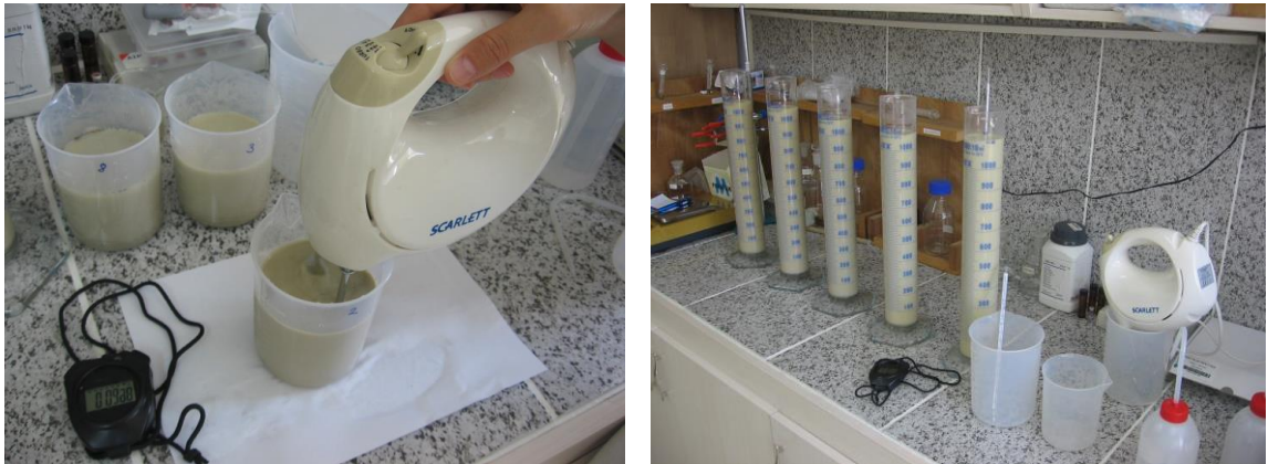
Şekil 3.13. Toprak ve sediment örneklerinin kum/kil/silt analizi
