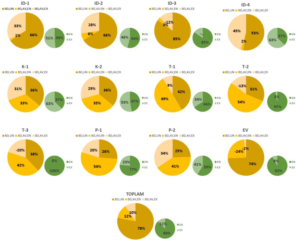
Şekil 4.4. Sistem bileşenlerinin ekserji yıkım oranlarının kaçınılmaz, kaçınılmaz içsel ve dışsal çevresel etkileri
